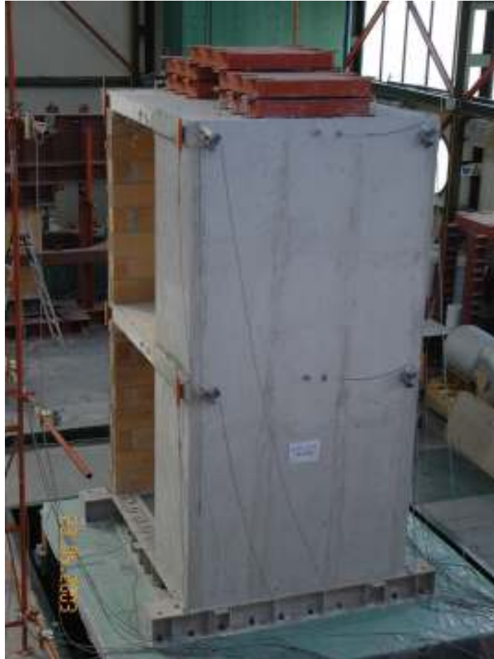
Εικόνα 13: Διώροφη κατασκευή χωρίς σεισμική μόνωση στη βάση
