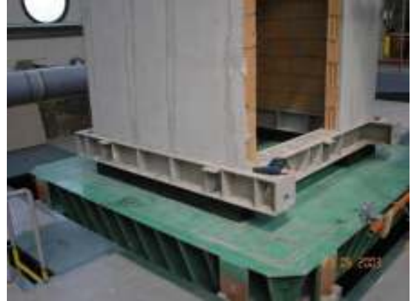
Εικόνα 11: Τοποθέτηση εφεδράνων στη βάση της κατασκευής
