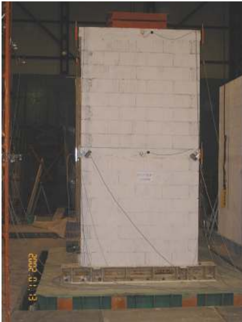
Εικόνα 1: Διώροφη άοπλη κατασκευή μη ενισχυμένη
