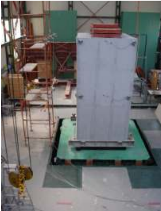
Εικόνα 10: Διώροφη κατασκευή ενισχυμένη με Armanent, σεισμικά μονωμένη
