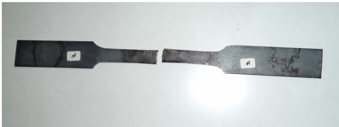
Εικόνα 4.19 Εξεταζόμενο δοκίμιο 2 με το πέρας του καταστρεπτικού ελέγχου
