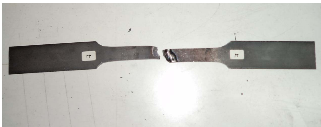
Εικόνα 4.24 Εξεταζόμενο δοκίμιο 7 με το πέρας του καταστρεπτικού ελέγχου
