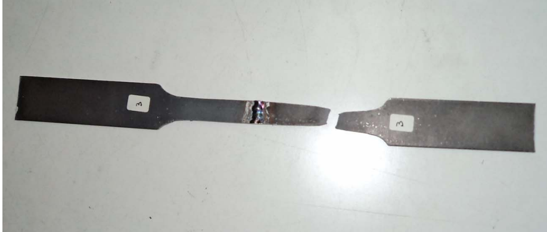
Εικόνα 4.20 . Εξεταζόμενο δοκίμιο 3 με το πέρας του καταστρεπτικού ελέγχου
