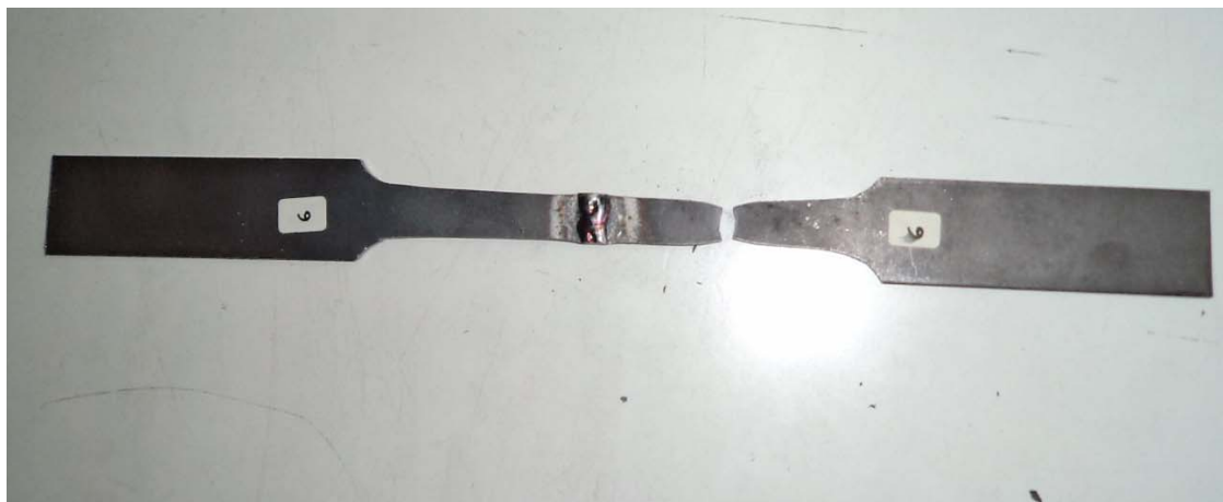
Εικόνα 4.23 Εξεταζόμενο δοκίμιο 6 με το πέρας του καταστρεπτικού ελέγχου
