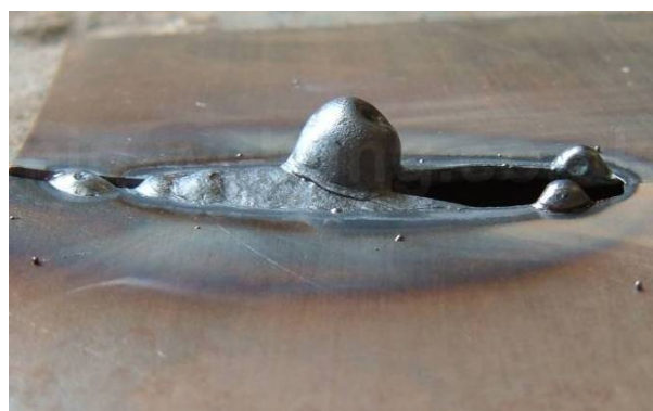
Εικόνα 2.5 Απεικόνιση σφάλματος κρατήρα (αριστερά) και διαμερούς τήξης (δεξιά)
