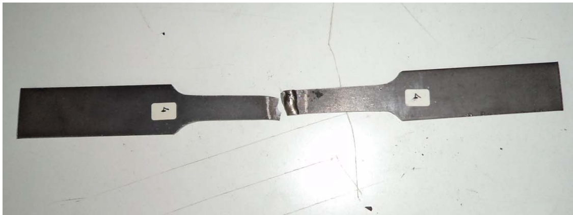
Εικόνα 4.21 Εξεταζόμενο δοκίμιο 4 με το πέρας του καταστρεπτικού ελέγχου
