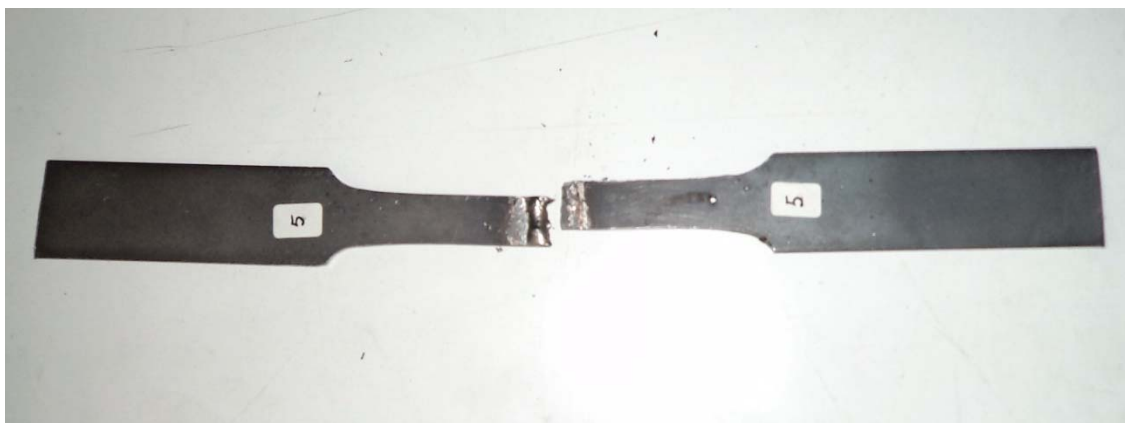
Εικόνα 4.22 Εξεταζόμενο δοκίμιο 5 με το πέρας του καταστρεπτικού ελέγχου
