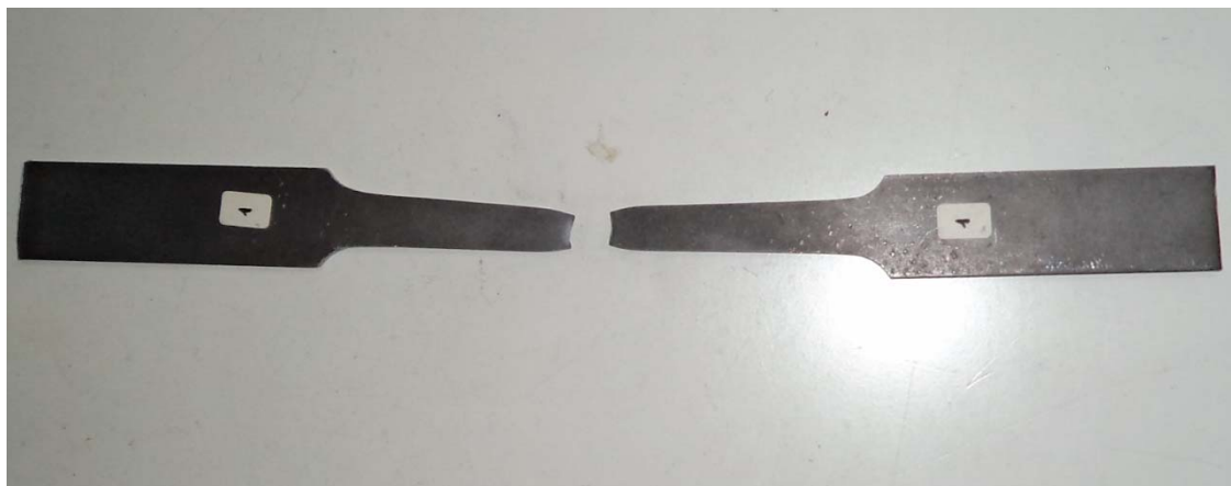
Εικόνα 4.18 Εξεταζόμενο δοκίμιο 1 με το πέρας του καταστρεπτικού ελέγχου
