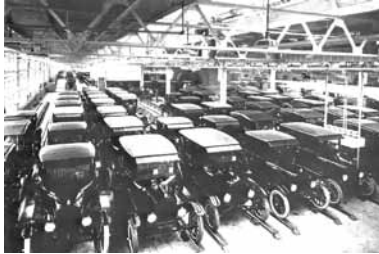
9,10. Μαζική παραγωγή του Μοντέλου T της Ford, του πρώτου μαζικά παραγόμενου αυτοκινήτου. Τη δεκαετία του 1920 η παραγωγή έφτασε τα 2.000.000 αυτοκίνητα ετησίως και με την τιμή του στα 240 δολάρια κατέστη προσιτό για αρκετές οικογένειες.
