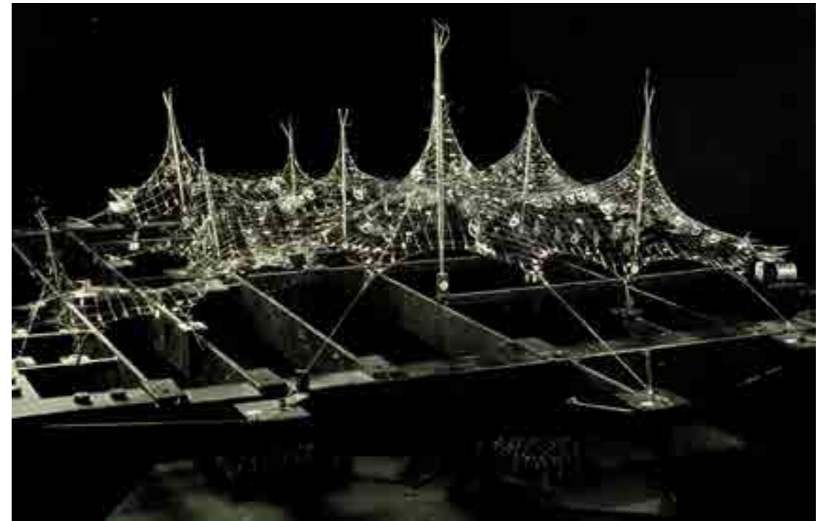
Ο νέος εξοπλισμός του εργαστηρίου II, ο πάγκος δυναμικών μετρήσεων. Είναι τοποθετημένο επάνω το πιστό μοντέλο της οροφής του Μόντρεαλ, σε κλίμακα 1:75. Από το μοντέλο αναρτώνται ισοδύναμα φορτία από μικρά βαρίδια. Κάτω βλέπουμε τις φωτογραφικές μηχανές για τις παράλληλες λήψεις (όχι προοπτικές) για εφαρμογή της μεθόδου της στερεο-φωτογραμμετρίας.
