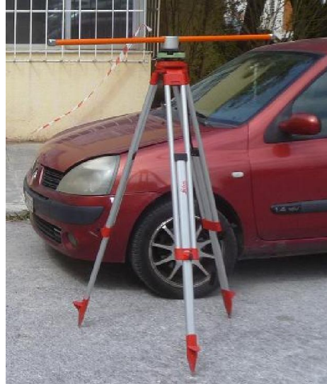
Σχήμα 4.10. Φωτογραφία της ράβδου κλίμακας εμπρός από το αντικείμενο προσδιορισμών.
