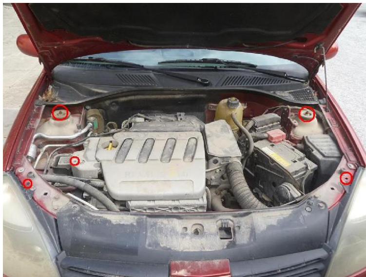
Σχήμα 4.2. Φωτογραφία εμπρόσθιου τμήματος σκελετού και σημεία ελέγχου,
