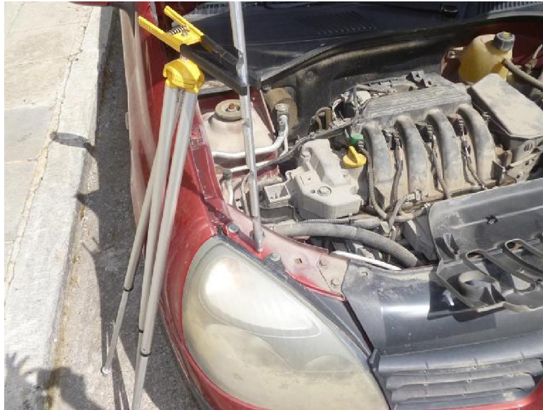
Σχήμα 4.4. Φωτογραφία, ράβδος κρουφού σημείου και βοηθητικός τρίποδας στήριξης
