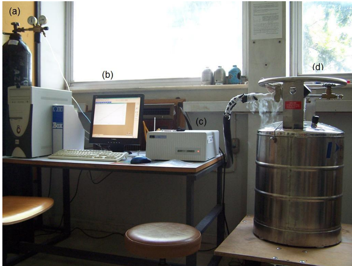
Σχήμα 3.2 Πειραματική διάταξη DSC που χρησιμοποιήθηκε. (a) Δοχείο με αέριο άζωτο, (b) υπολογιστής για την επεξεργασία των πειραματικών δεδομένων, (c) θερμιδόμετρο Pyris 6, (d) δοχείο Dewar με υγρό άζωτο.
