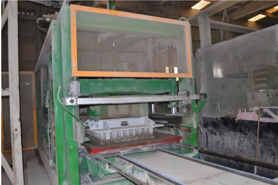
Εικόνα 13 Μηχανή παραγωγής κυβόλιθων Lorev, μοντέλο LC-100
