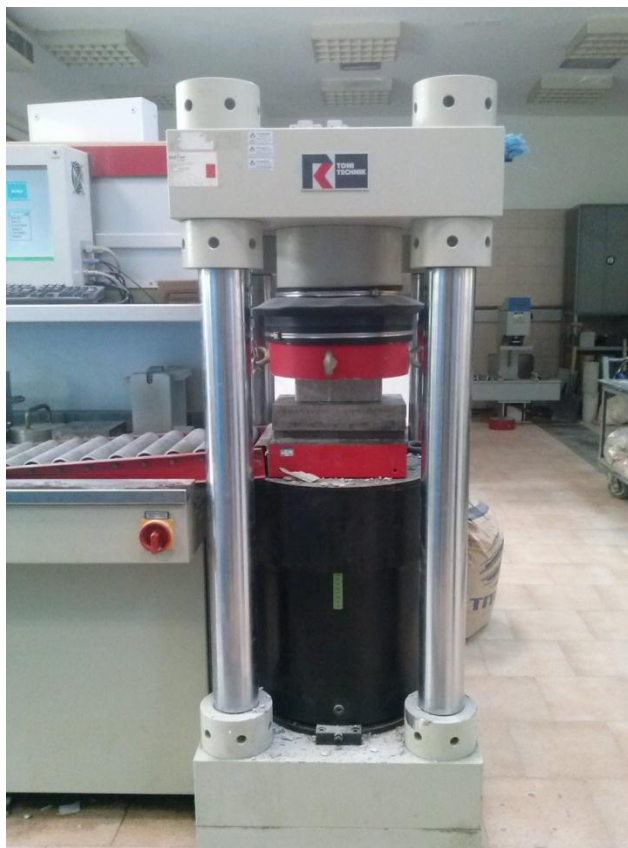
Εικόνα 22 Η πρέσα Toni Tecknik: Compression Testing Machine
