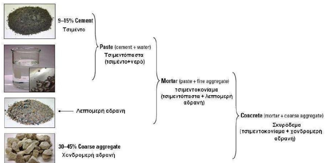
Εικόνα 1 Σχηματική απεικόνιση της συμμετοχής των πρώτων υλών στο σκυρόδεμα
