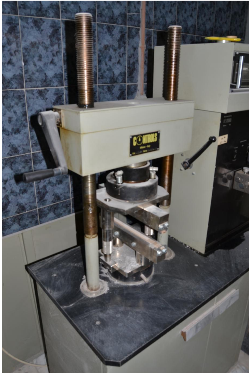
Εικόνα 19 Πρέσα Controls C 42/1
