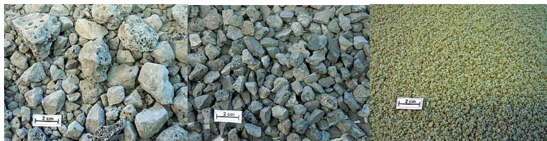
Εικόνα 3 α) Αερόψυκτη σκωρία υψικαμίνων (Air-cooled blast furnace slag, coarse aggregate), χονδρόκοκκο αδρανές β) Σκωρία καμίνου παρουσία οξυγόνου (Basic oxygen furnace slag, coarse aggregate) γ) Κοκκοποιημένη σκωρία υψικαμίνων (Granulated blast furnace slag (GBS), fine aggregate)
