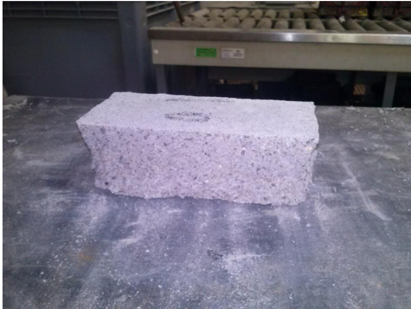
Εικόνα 23 Δοκίμιο της σύνθεσης Σ-10 μετά τη θλίψη
