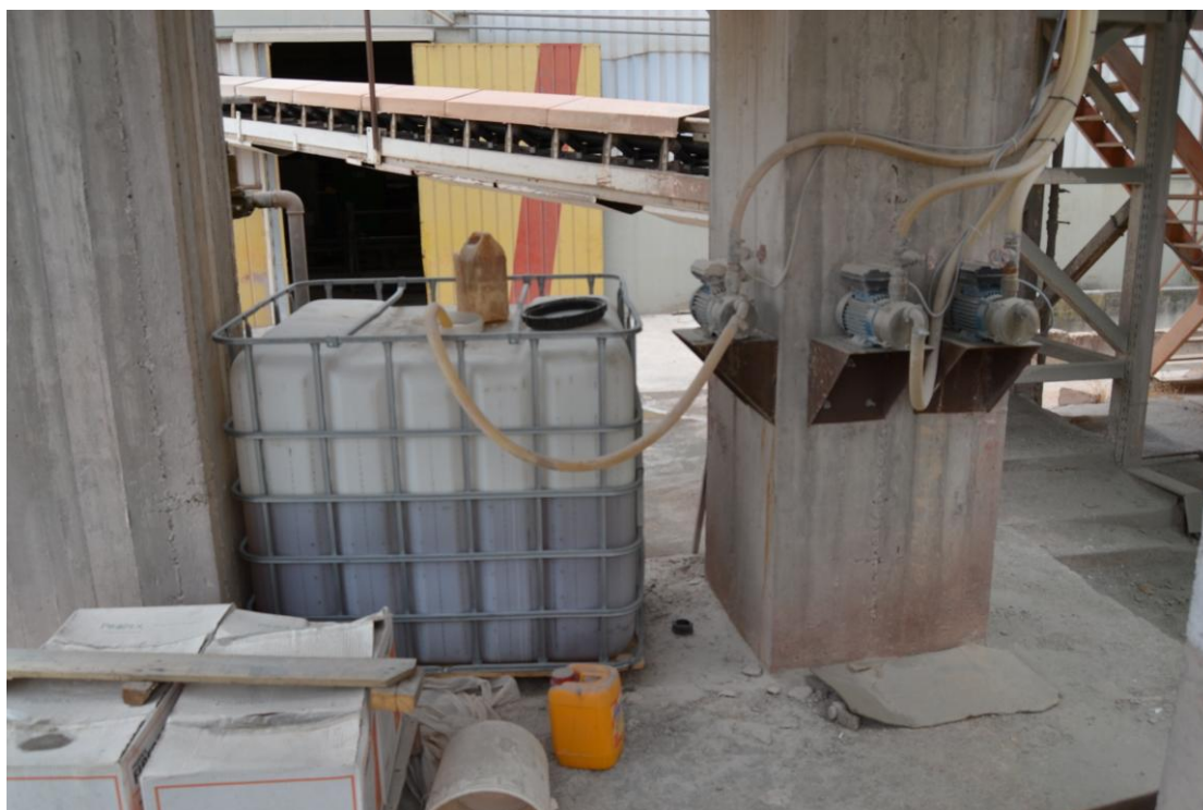
Εικόνα 15 Ο υπερρευστοποιητής οδηγείται στη παραγωγή με τη βοήθεια αντλιών
