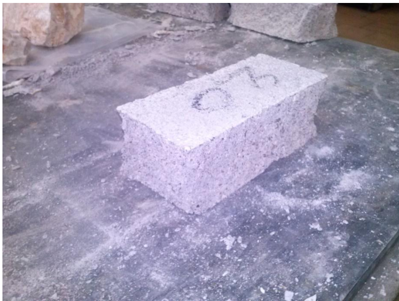
Εικόνα 24 Δοκίμιο της σύνθεσης Σ-20 μετά τη θλίψη
