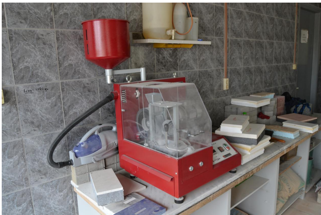
Εικόνα 21 Μηχανή για μέτρηση της αντοχής σε τριβή GT0112 (Gabrielli technology)
