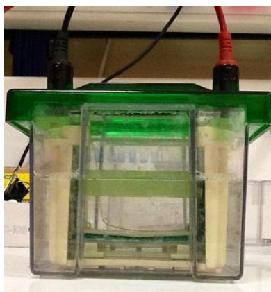
Σχήμα 2.13 Συσκευή ηλεκτροφόρησης πρωτεϊνών που Mini-Protean 3 (Biorad, Η.Π.Α.)
