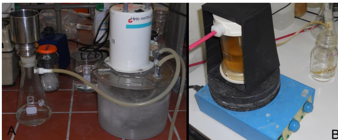
Σχήμα 2.6. (Α) Διάταξη διήθησης υπό κενό, (Β) συσκευή υπερδιήθησης Amicon Stirred Cell 8400 με μεμβράνη PM-10/30 (Millipore, Η.Π.Α.)
