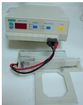
Σχήμα 2.3. Συσκευή ηλεκτροδιάτρησης Micropulser™ (Biorad, Η.Π.Α.)
