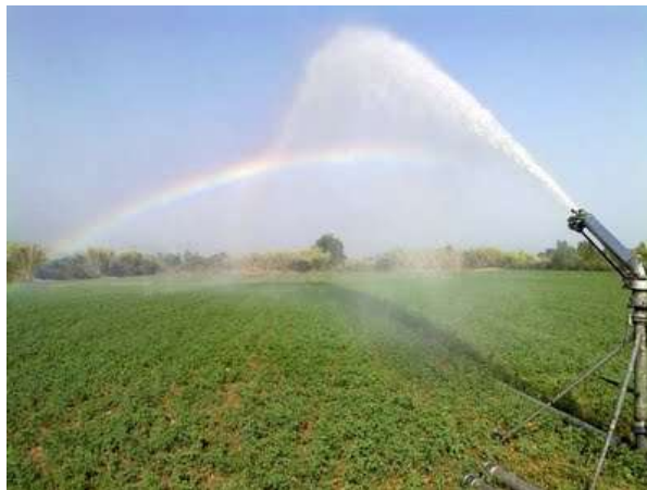
Σχήμα 5.4 Μέθοδος Άρδευσης Με Καταιονισμό
