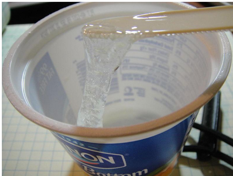
Σχ. 5.2: Εποξικό συνδετικό υλικό – μείγμα εποξικής ρητίνης και σκληρυντικού μέσου
