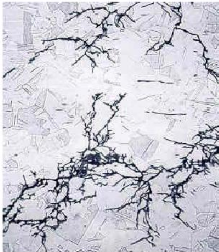
Σχ.2.9: Διάβρωση με μηχανική καταπόνηση χαλύβδινης σωλήνωσης
