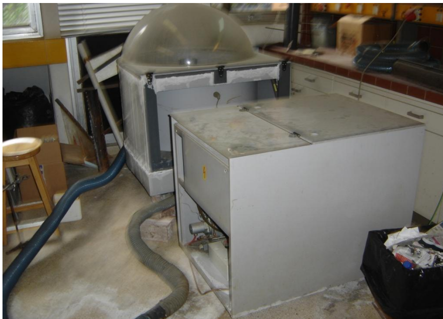
Σχ.7.3: Θάλαμος αλατονέφωσης εργαστηρίου
