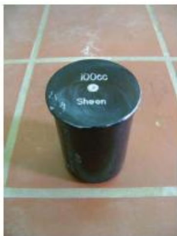
Σχήμα 7.39 : Κυλινδρικό δοχείο όγκου 100cc με επίστρωμα αστάρι μετάλλων γκρι
