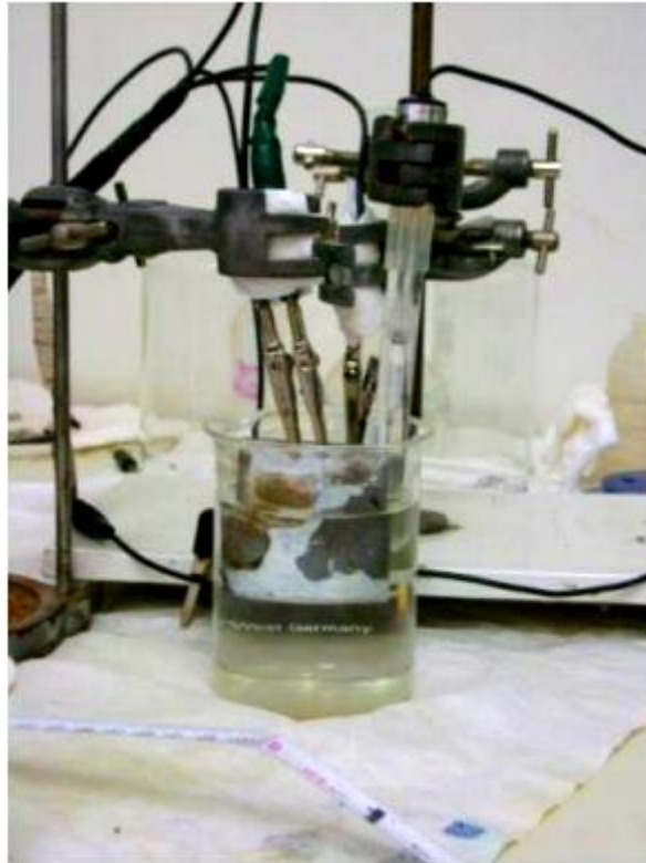
Σχ:7.17: Διάταξη για την λήψη καμπυλών του εργαστηρίου Χημικών Μηχανικών.
