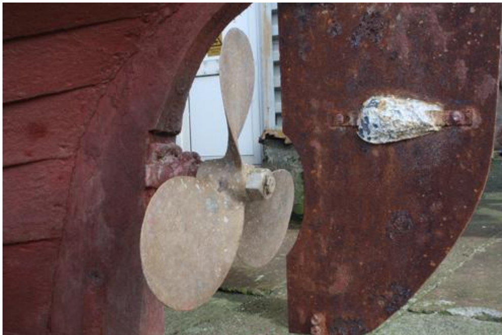
Σχ.4.3: Προστασία με θυσιαζόμενα ηλεκτρόδια απο ψευδάργυρο σε πηδάλιο πλοίου
