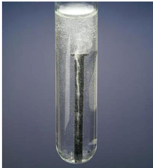
Σχ. 2.2: Χημική διάβρωση – ομοιόμορφη απομάκρυνση Fe κατά την προσβολή του από HCl
