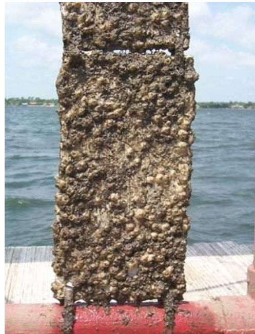
Σχ.2.5: Βιολογική διάβρωση σε ύφαλα πλοίου
