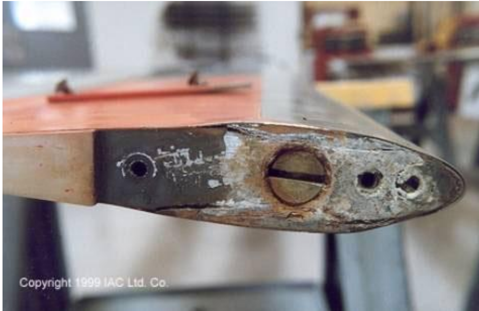
Σχ.2.1: Ηλεκτροχημική διάβρωση με δημιουργία τοπικού γαλβανικού στοιχείου (γαλβανική διάβρωση)
