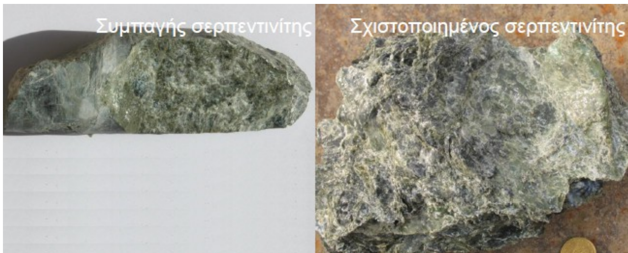
Εικόνα 2.17: Συμπαγής και σχιστοποιημένος σερπεντινίτης (τύπος III) [10]
