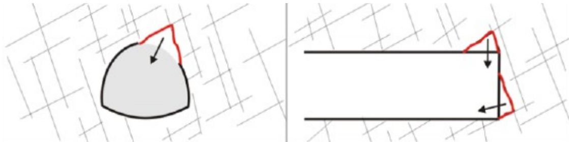
Σχήμα 2.13: Πιθανή αστοχία - Κατηγορία I [10]
