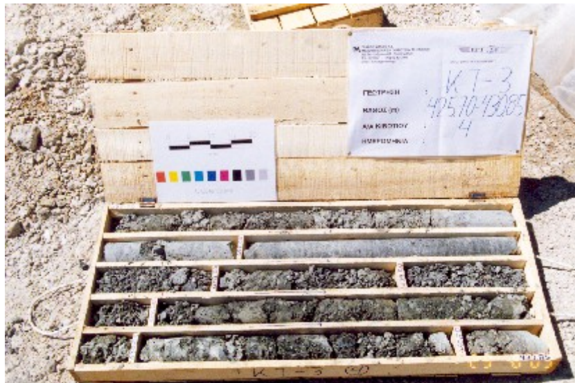
Εικόνα 4.2: Σχιστώδης Σερπεντινίτης (se.s) & Σερπεντινίτης (se) όπως λήφθηκε από τη γεώτρηση KT-3 σε βάθος 425,70 - 430,85 μέτρα [17]
