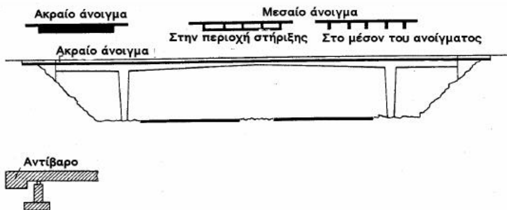
Σχήμα 3.1.3.4.1 Πλαισιωτή γέφυρα με διαφορετικές διατομές. 17
