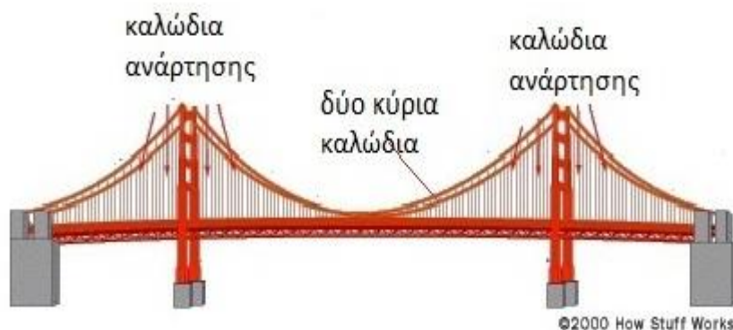
Εικόνα 3.1.3.8.1 Όψη αναρτημένης γέφυρας. 28
