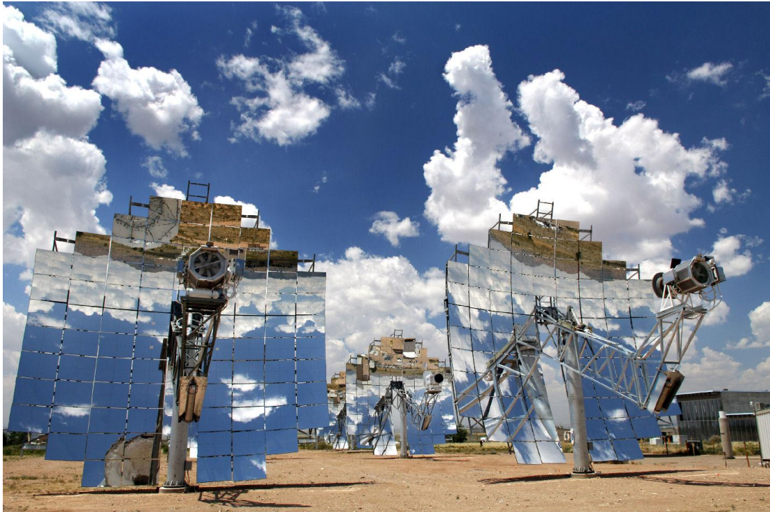
Σχήμα1. 7: Τυπική Εγκατάσταση συστήματος Ηλιακού Δίσκου
