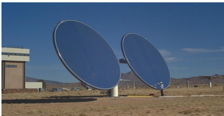
Σχήμα 3. 3 Τυπικό σχήμα Ηλιοστάτη τεχνολογίας "stretched membrane"
