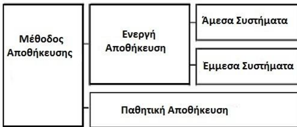
Σχήμα 2. 10: Διαχωρισμός συστημάτων αποθήκευσης (17)
