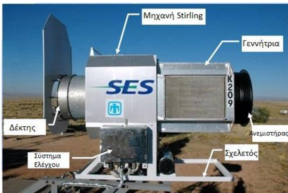
Σχήμα 4. 4: Τμήμα παραγωγής ενέργειας, συστήματος “Suncatcher” (31)
