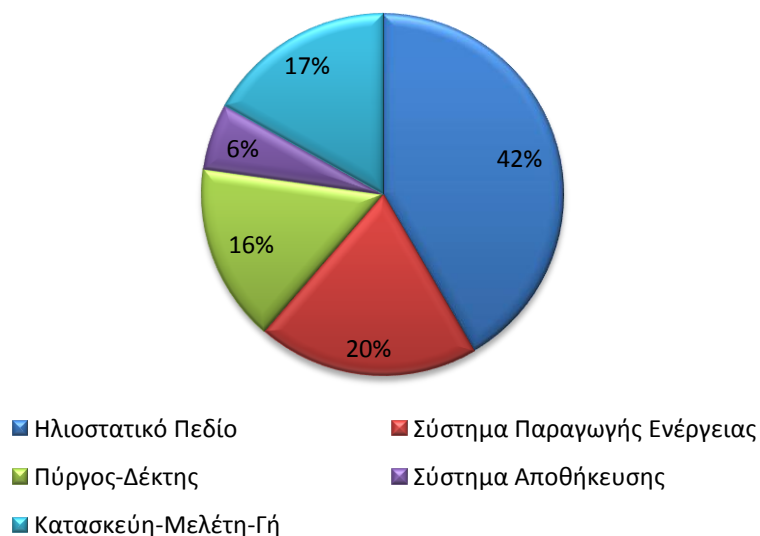
Σχήμα 3. 18: Επιμερισμός Κόστους Εγκατάστασης Συστήματος Ηλιακού Πύργου (20)
