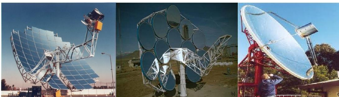
Σχήμα 4. 3: Τυπικές διατάξεις συστήματος ηλιακού δίσκου με διαφορετικού είδους συγκεντρωτικές επιφάνειες: α) από πολύπλευρες γυάλινες επιφάνειες, β) τεντωμένης μεμβράνης, γ) Πλήρως παραβολική Επιφάνεια
