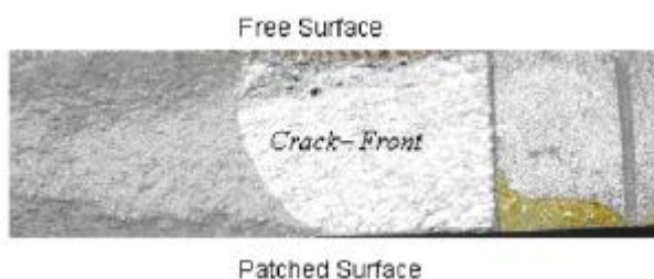
Σχήμα 1.9: Καμπυλόγραμμο μέτωπο ρωγμής από κόπωση κατά το πάχος μονόπλευρα ενισχυμένου ελάσματος αλουμινίου.
