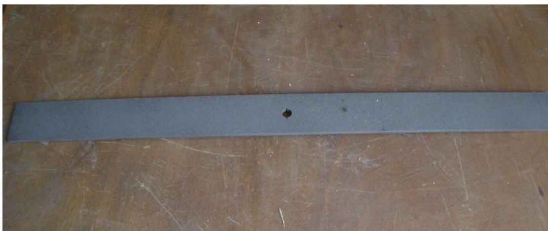
Σχήμα 3.3: Δοκίμιο μετά από αμμοβολή και άνοιγμα οπής.
