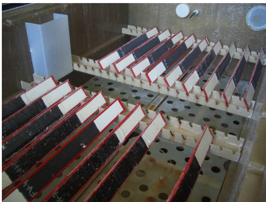
Σχήμα 3.19: Δοκίμια μέσα στο θάλαμο αλατονέφωσης.
