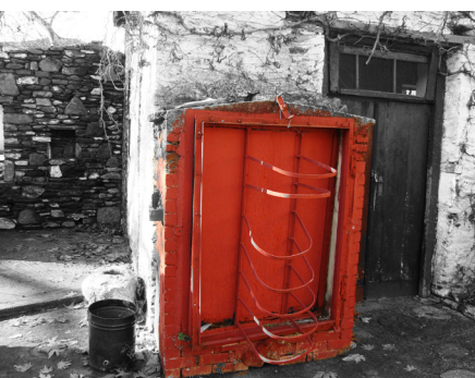
Παραδοσιακός φούρνος για την απόπνιξη του κουκουλιού. Βρίσκεται στην αυλή ενός σπιτιού του οικισμού.
