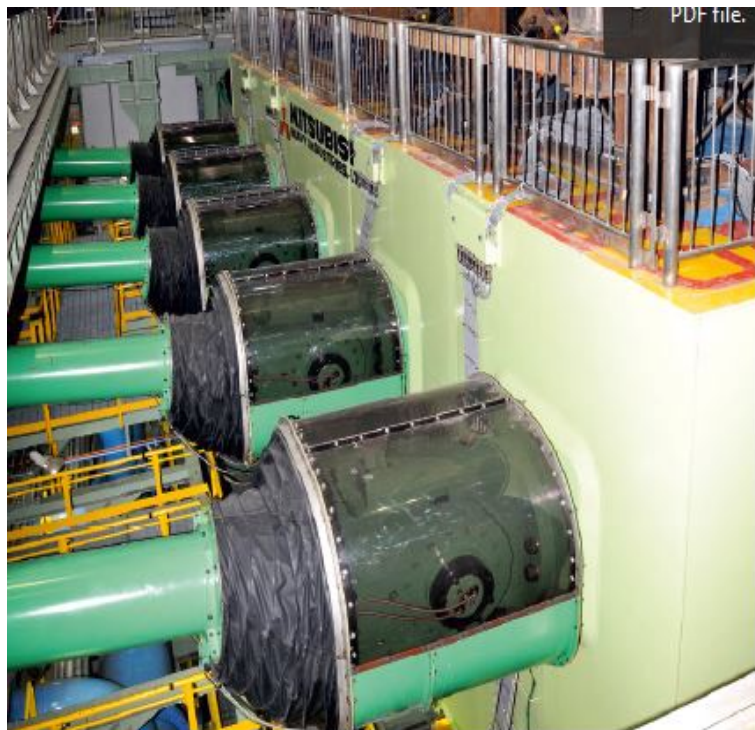
Σχήμα 2.1 : Σεισμική Τράπεζα E-DEFENSE
