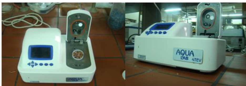
Εικόνα 5.5. Εξοπλισμός μέτρησης ενεργότητας νερού (AquaLab 4TEV, Decagondevices, USA)
