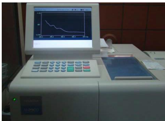
Εικόνα 5.4: Φασματοφωτόμετρο UV-Vis (UV-Vis HitachiU 2900) που χρησιμοποιήθηκε για τον προσδιορισμό των απορροφήσεων
