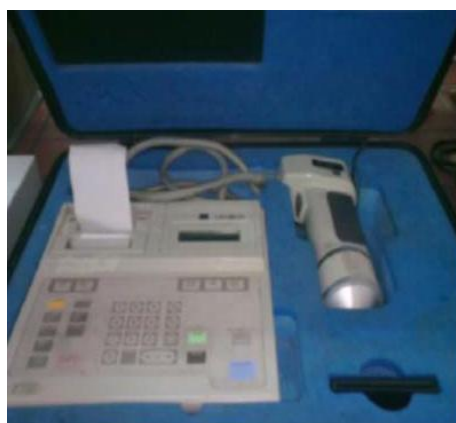
Εικόνα 5.3: Συσκευή μέτρησης χρώματος Minolta CR-200 (Minolta Co., Chuo - Ku, Osaka, Japan)
