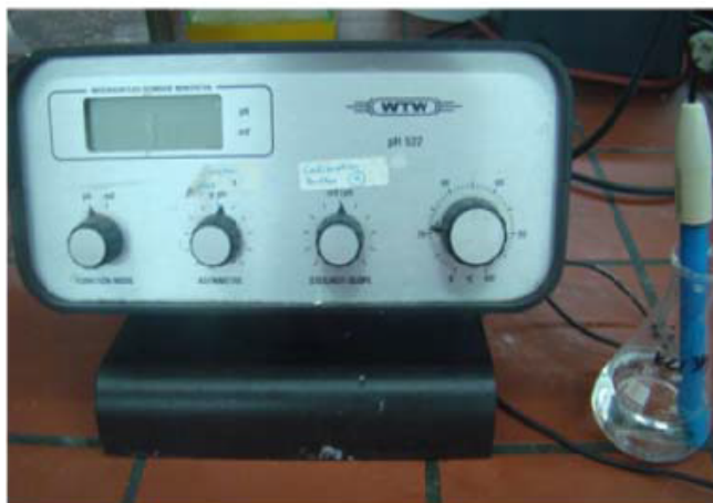
Εικόνα 5.1: Συσκευή μέτρησης pH (UV Bayern, WTW Bayern, Germany)
