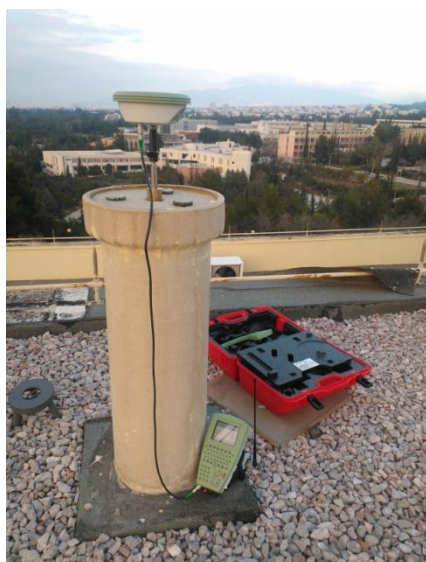
Εικόνα 4-12. Συνδεσμολογία Σταθερού Δέκτη Leica
