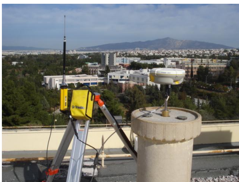
Εικόνα 4-14. Συνδεσμολογία Σταθερού Δέκτη Trimble
