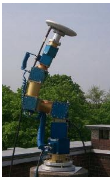
Εικόνα 2-14. Απεικόνιση του Ρομπότ-Βάσης Βαθμονόμησης (Πηγή : Wübbena et al, 2000)
