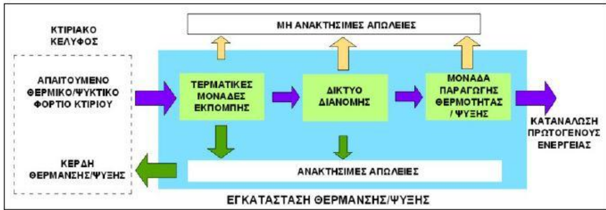
Σχήμα 4.1: Διάγραμμα διαδικασίας σχεδιασμού εγκατάστασης θέρμανσης/ψύξης
