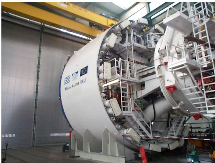
Εικόνα 2.9 Σύστημα τοποθέτησης προκατασκευασμένων στοιχείων (Πηγή: Αττικό Μετρό Α.Ε.)
