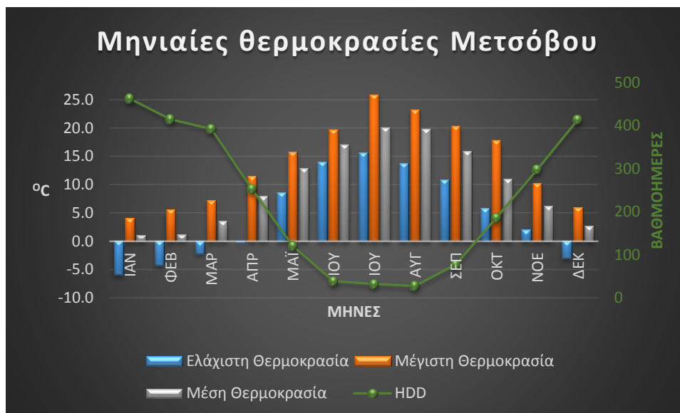
Διάγραμμα 7: Μηνιαίες βαθμομέρες θέρμανσης και ελάχιστες, μέγιστες μέσες μηνιαίες θερμοκρασίες για την περιοχή του Μετσόβου
