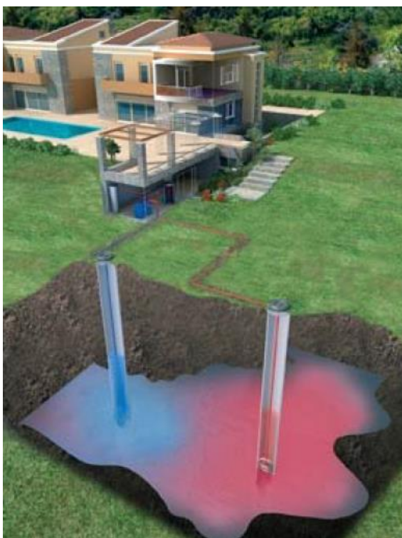
Εικόνα 13: Σύστημα ανοιχτού βρόγχου, Πηγή: (Τομαράς,2013)
