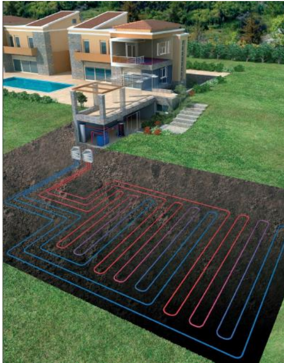
Εικόνα 15: Σύστημα οριζόντιου γεωεναλλάκτη, Πηγή: (Τομαράς, 2013)
