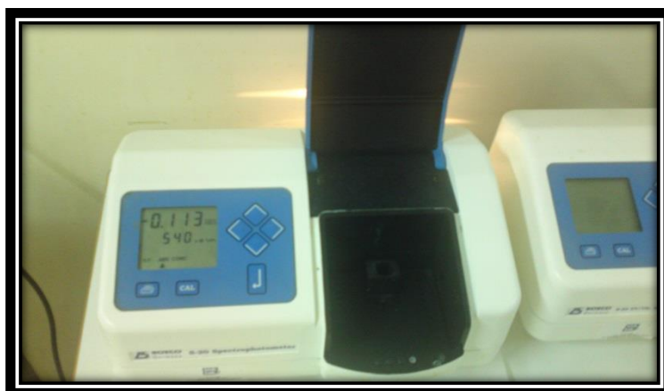
Εικόνα 2.3-35. Φωτόμετρο (μέτρηση απορρόφησης στα 540 nm)
