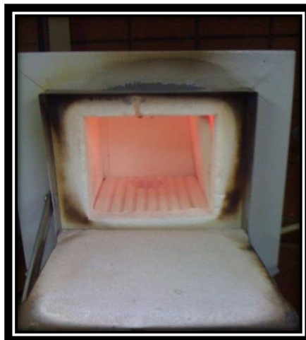
Εικόνα 2.3-22. Φούρνος μέτρησης πτητικών στερεών στους 550°
