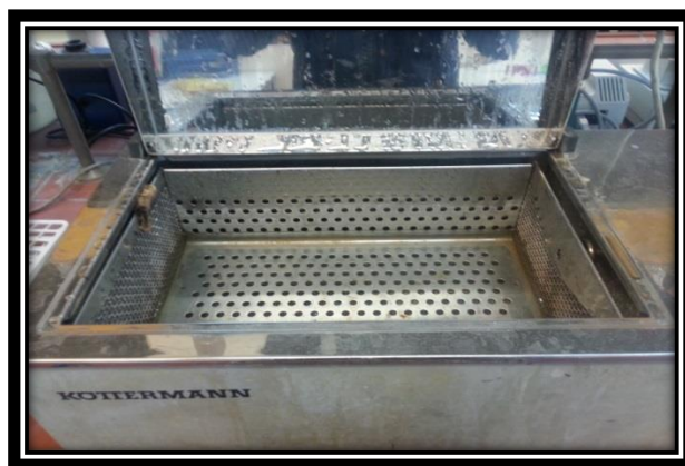
Εικόνα 2.3-25. Υδατόλουτρο με ανάδευση στους 65°C
