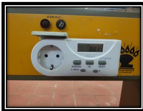
Εικόνα 2.3-6. Συσκευή καταγραφής ενεργειακής κατανάλωσης
