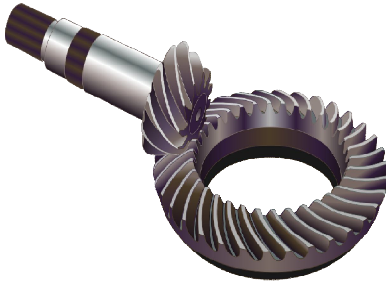
Σχήμα 3.1 : Τοξωτοί κωνικοί οδοντωτοί τροχοί σε συνεργασία.
