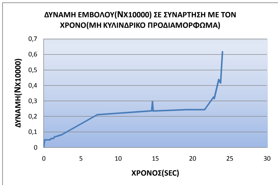
Σχήμα 8.4 : Διάγραμμα δύναμης εμβόλου σε συνάρτηση με τον χρόνο για το μή κυλινδρικό.
