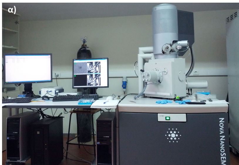
εικ. 5.6: Το ηλεκτρονικό μικροσκόπιο σάρωσης α) και το σύστημα επιμετάλλωσης δειγμάτων β) του Τομέα Φυσικής του Ε.Μ.Π.
