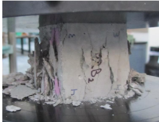
Εικ. 17.3 Το δοκίμιο BRb 2 καθώς συνθλίβεται από την μηχανή και φαίνεται η μορφή θραύσης.
