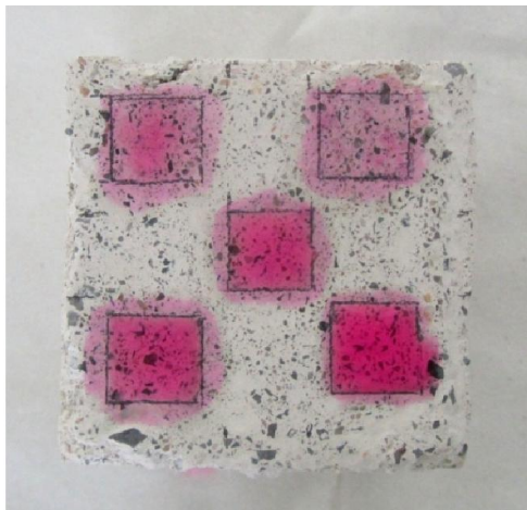
Εικ. 12.1 Το δείγμα W την στιγμή που μόλις έχει εφαρμοστεί η χρωστική πάνω στην επιφάνεια του. (Αριστερά) η εφαρμογή της Ροδαμίνης Β στην πάνω πλευρά όπου φαίνεται το άπλωμα της χρωστικής στην επιφάνεια, και (Δεξιά) η εφαρμογή στην βάση του κύβου όπου φαίνεται η παραμονή του υδατοδιαλύματος μέσα στα τετράγωνα.
