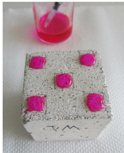
Εικ. 12.1 Το δείγμα W την στιγμή που μόλις έχει εφαρμοστεί η χρωστική πάνω στην επιφάνεια του. (Αριστερά) η εφαρμογή της Ροδαμίνης Β στην πάνω πλευρά όπου φαίνεται το άπλωμα της χρωστικής στην επιφάνεια, και (Δεξιά) η εφαρμογή στην βάση του κύβου όπου φαίνεται η παραμονή του υδατοδιαλύματος μέσα στα τετράγωνα.
