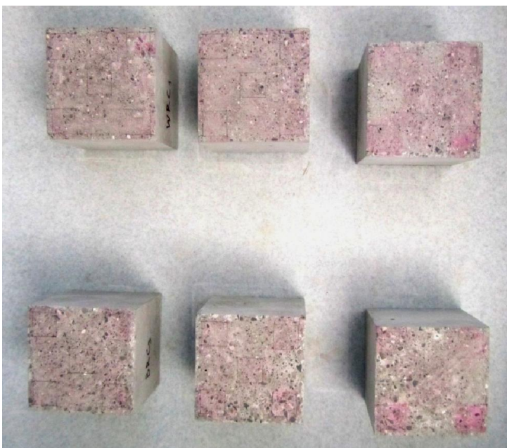
Εικ. 12.1 Το δείγμα W την στιγμή που μόλις έχει εφαρμοστεί η χρωστική πάνω στην επιφάνεια του. (Αριστερά) η εφαρμογή της Ροδαμίνης Β στην πάνω πλευρά όπου φαίνεται το άπλωμα της χρωστικής στην επιφάνεια, και (Δεξιά) η εφαρμογή στην βάση του κύβου όπου φαίνεται η παραμονή του υδατοδιαλύματος μέσα στα τετράγωνα.
