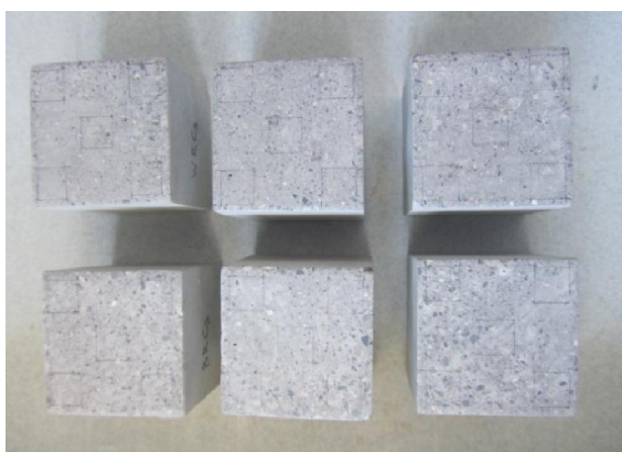
Εικ. 7.2 Τα δείγματα WRc και BRc, αριστερά με καθορισμένα τα τετράγωνα για την εφαρμογή της χρωστικής και δεξιά μία ημέρα αφότου έχει εφαρμοστεί σε αυτά Ροδαμίνη Β (φαίνεται το “άπλωμα” της χρωστικής εκτός των ορίων των τετραγώνων).
