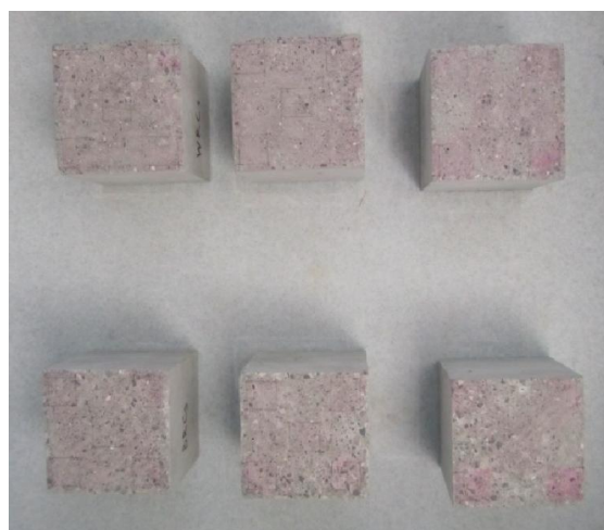
Εικ. 7.2 Τα δείγματα WRc και BRc, αριστερά με καθορισμένα τα τετράγωνα για την εφαρμογή της χρωστικής και δεξιά μία ημέρα αφότου έχει εφαρμοστεί σε αυτά Ροδαμίνη Β (φαίνεται το “άπλωμα” της χρωστικής εκτός των ορίων των τετραγώνων).
