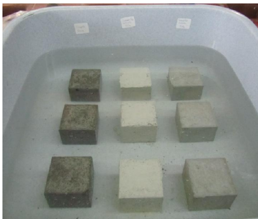
Εικ. 4.3 Τα δείγματα R, W, B βυθισμένα σε νερό.
