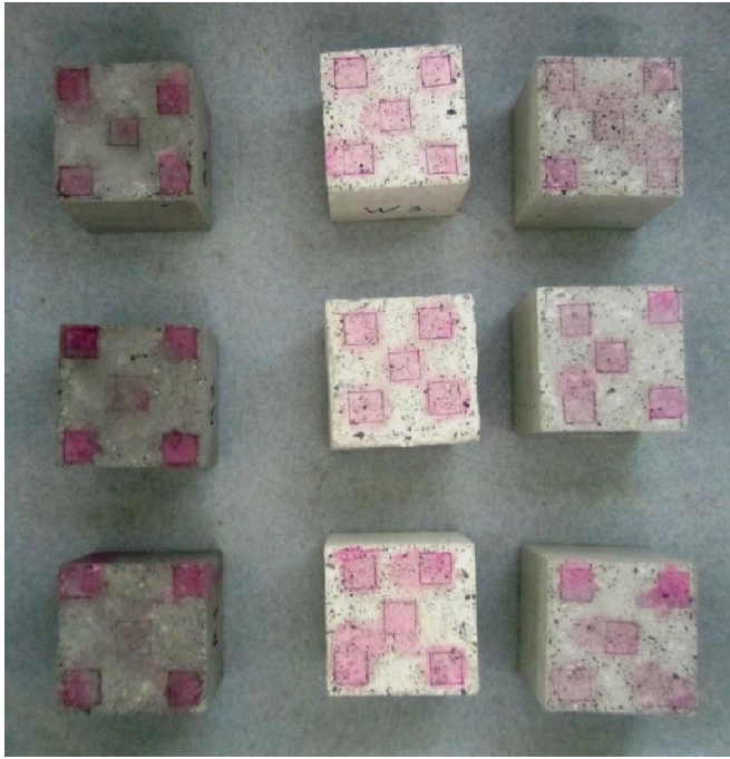
Εικ. 12.3 Αριστερά τα δείγματα R , W , B ενώ έχει εφαρμοστεί στην πάνω πλευρά τους Ροδαμίνη B πριν μπουν στον αντιδραστήρα. Δεξιά τα δείγματα WRa , WRb , BRa , BRb ενώ έχει εφαρμοστεί στην πάνω πλευρά τους Ροδαμίνη B πριν μπουν στον αντιδραστήρα. Φαίνεται και στις δύο εικόνες ότι η Ροδαμίνη B έχει απλώσει πάνω στην επιφάνεια εκτός των τετραγώνων.
