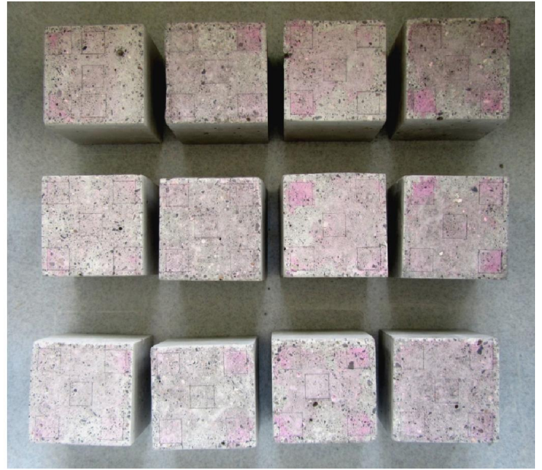
Εικ. 12.3 Αριστερά τα δείγματα R , W , B ενώ έχει εφαρμοστεί στην πάνω πλευρά τους Ροδαμίνη B πριν μπουν στον αντιδραστήρα. Δεξιά τα δείγματα WRa , WRb , BRa , BRb ενώ έχει εφαρμοστεί στην πάνω πλευρά τους Ροδαμίνη B πριν μπουν στον αντιδραστήρα. Φαίνεται και στις δύο εικόνες ότι η Ροδαμίνη B έχει απλώσει πάνω στην επιφάνεια εκτός των τετραγώνων.
