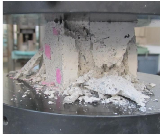
Εικ. 17.5 Το δοκίμιο W 2 καθώς συνθλίβεται από την μηχανή και φαίνεται η μορφή θραύσης.
