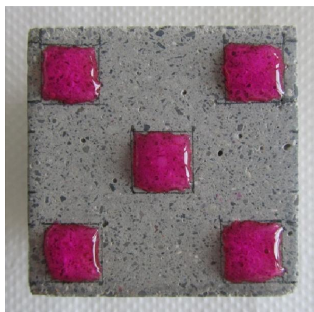
Εικ. 5.1 (Αριστερά) Σχήμα στις πραγματικές διαστάσεις που δείχνει την επιφάνεια του δοκιμίου και τα καθορισμένα τετράγωνα όπου γίνεται η απόθεση της χρωστικής. (Δεξιά) Φωτογραφία από δοκίμιο στο οποίο έχει εναποτεθεί η χρωστική σε πραγματικές διαστάσεις.
