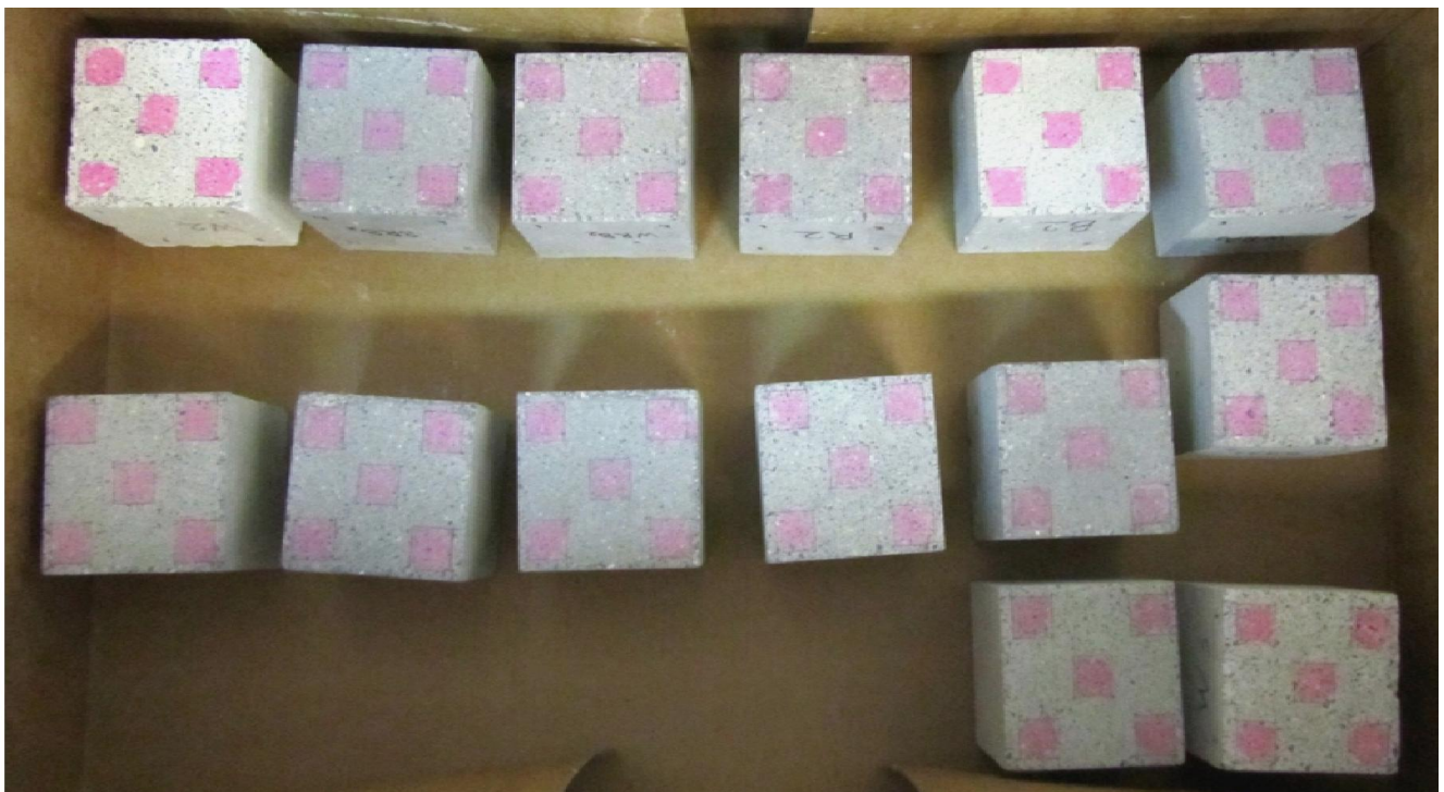
Εικ. 12.4 Τα δείγματα R , W , B και WRa , WRb , BRa , BRb ενώ έχει εφαρμοστεί στην βάση τους Ροδαμίνη B . Φαίνεται πώς έχει παραμείνει η χρωστική μέσα στα όρια των προκαθορισμένων τετραγώνων.
