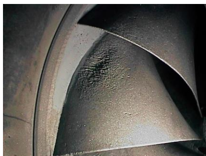
Εικόνα 14. Υδροστρόβιλος Francis με εμφάνιση σπηλαιώσης. (πηγή: khia.belzona.com/)
