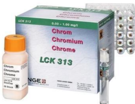
Εικόνα 3.28: Φιαλίδια της εταιρίας Hach Lange με κωδικό LCK 313, που χρησιμοποιούνται για τον προσδιορισμό της συγκέντρωσης διαλυτού Cr(VI), με αντίστοιχο εύρος τιμών από 2,5 έως 250 μg/l.
