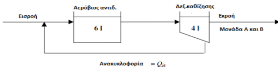
Σχήμα 2.3: Διάγραμμα ροής των αερόβιων πιλοτικών μονάδων ενεργού ιλύος Α και Β για την απομάκρυνση Cr(VI). (Πηγή: Statinakis et al., 2004)
