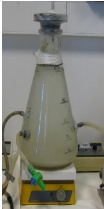
Εικόνες 3.7: Απεικόνιση της γυάλινης, βαθμονομημένης, κωνικής φιάλης, του ειδικά σχεδιασμένου άνω πώματος και του μαγνητικού αναδευτήρα.
