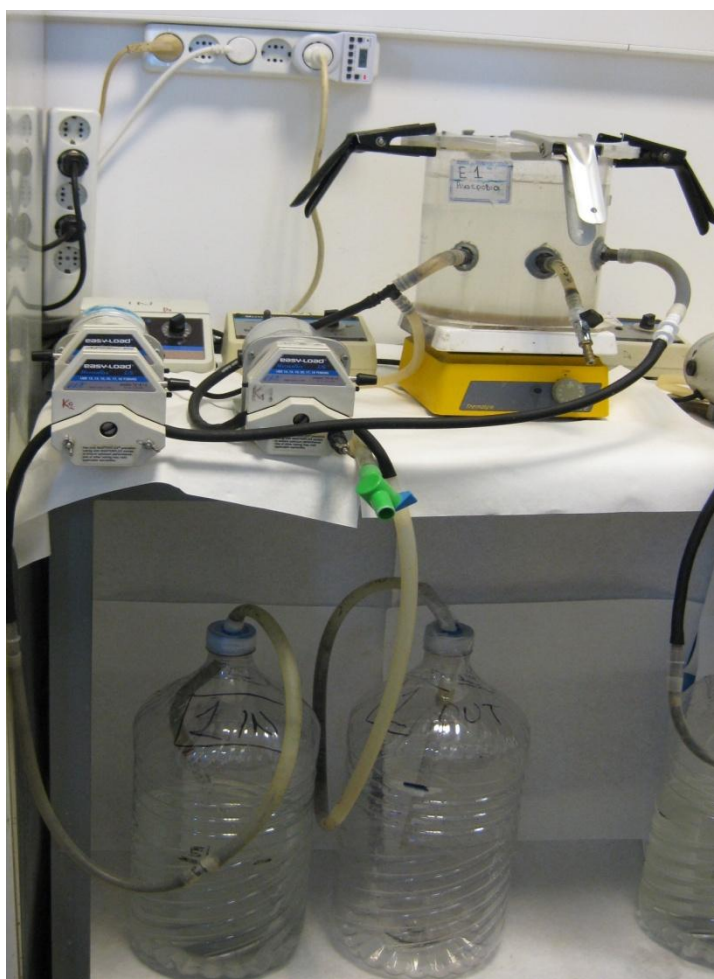
Εικόνα 3.1: Απεικόνιση του αυτόματου αναερόβιου συστήματος τριπλής τροφοδοσίας και \theta_c 10 ημερών (1 ο σύστημα).
