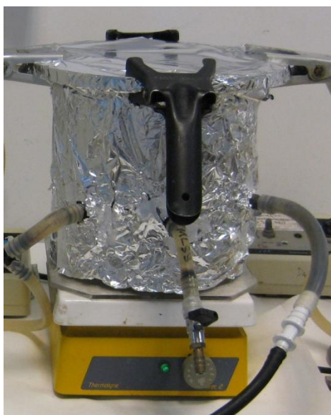
Εικόνα 3.6: Απεικόνιση του αντιδραστήρα, κυκλικής διατομής, από Plexiglas, που φιλοξένησε τη μικροβιακή κοινότητα για το πρώτο χρονικό διάστημα λειτουργίας του 3 ου συστήματος.
