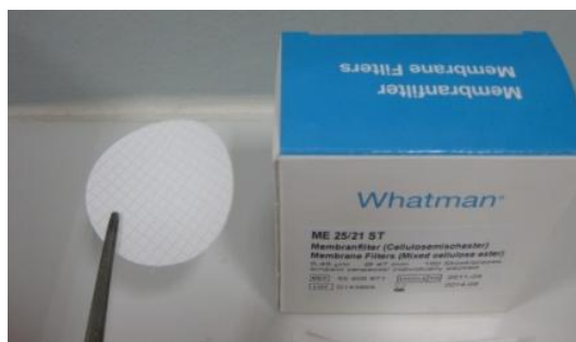
Εικόνα 3.27: Απεικόνιση μεμβράνης με διάμετρο πόρων 0,45 μm, που χρησιμοποιούνται για τη διήθηση των δειγμάτων.
