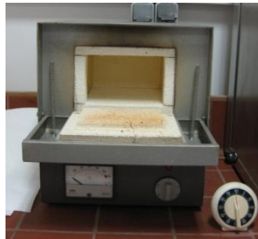
Εικόνες 3.21: Απεικόνιση του φίλτρου και του πυριαντηρίου που χρησιμοποιούνταν στη διαδικασία προξήρανσης των φίλτρων.
