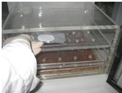
Εικόνα 3.22: Τοποθέτηση του προξηραμένου φίλτρου στον ξηραντήρα.
