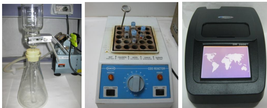
Εικόνες 3.26: Συσκευή διήθησης, χωνευτής για φιαλίδια COD και φασματοφωτόμετρο HACH.
