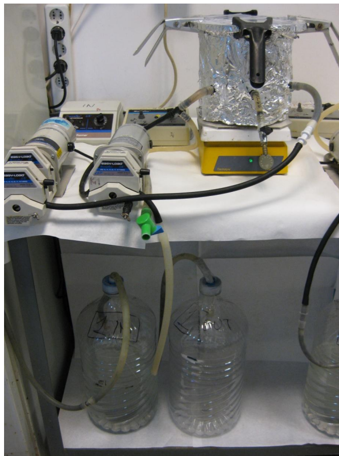
Εικόνα 3.5: Απεικόνιση του αυτόματου αναερόβιου συστήματος τριπλής τροφοδοσίας και θ c 20 ημερών (2 ο σύστημα) με προστασία από την ηλιακή ακτινοβολία.
