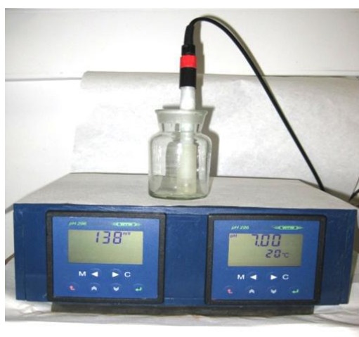
Εικόνες 3.14: Συσκευή μέτρησης οξειδοαναγωγικού δυναμικού και το αντίστοιχο ηλεκτρόδιο.
