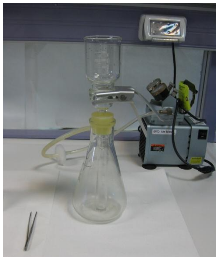
Εικόνες 3.20: Αριστερά η μονή συσκευή διήθησης με χρήση αντλίας κενού και δεξιά ο ξηραντήρας.
