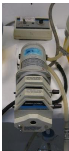
Εικόνες 3.3: Απεικόνιση της περισταλτικής αντλίας διπλής κεφαλής και των πλαστικών φιασκών που χρησιμοποιήθηκαν στην πειραματική διάταξη του 1 ου συστήματος.
