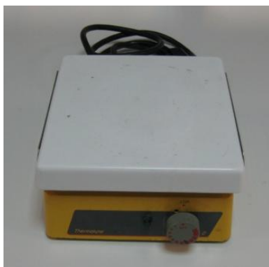
Εικόνες 3.2: Απεικόνιση του μαγνητικού αναδευτήρα και των ηλεκτρονικών χρονοδιακοπών που χρησιμοποιήθηκαν στην πειραματική διάταξη του 1 ου συστήματος.
