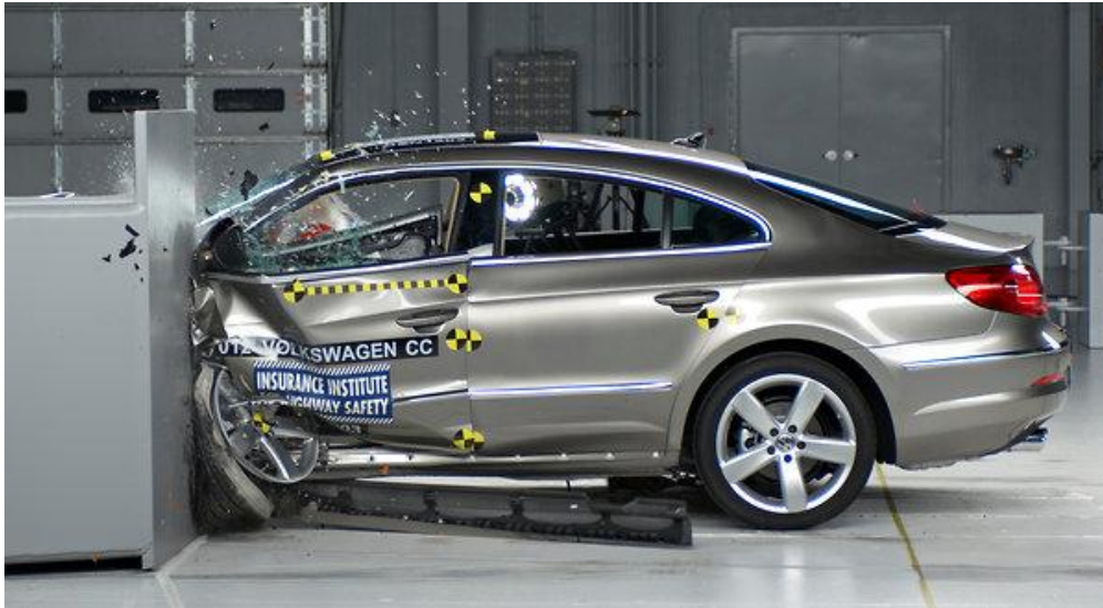
Σχήμα 2: Προσομοίωση σύγκρουσης οχήματος σε ακίνητο εμπόδιο
