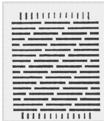
Σχήμα 10: Αποτύπωμα πλέξης νημάτων 4 επάνω – 1 κάτω.
