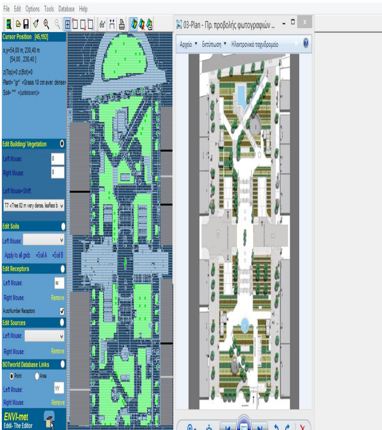
Εικ.6.13: Μοντέλο κτιρίων και φυτών της πλατείας Καρόλλου [Πηγή: ENVI-met]
