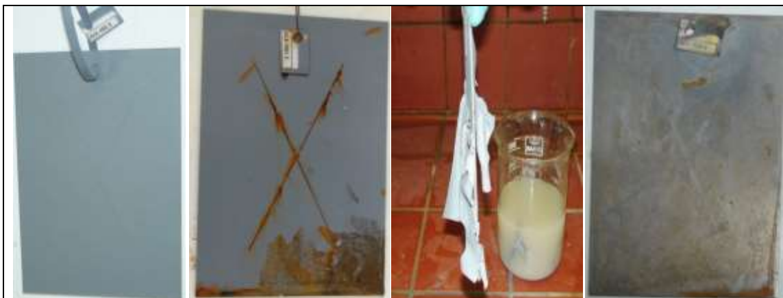
Εικόνα 6-13 «Διαδικασία καθαρισμού δοκιμίων»
