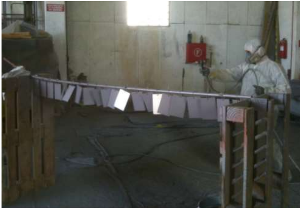
Εικόνα 6-11 «Διαδικασία βαψίματος δοκιμών στο εργοστάσιο»
