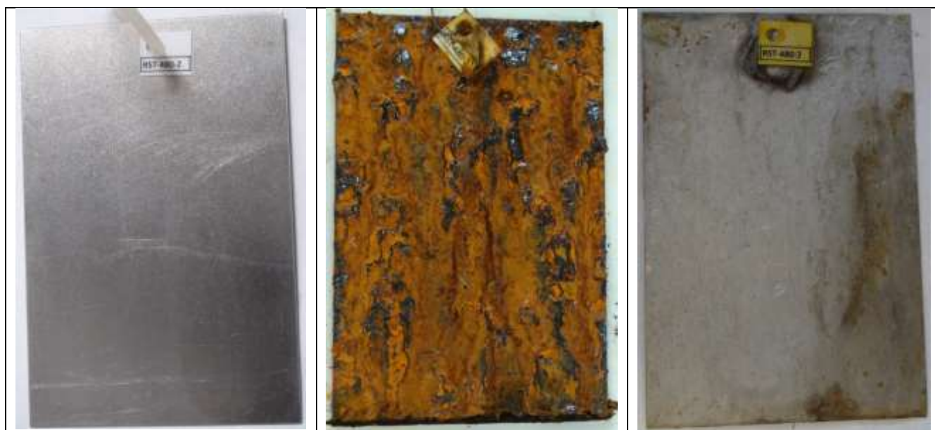
Εικόνα 6-16 « Διαδικασία καθαρισμού δοκιμίων»
