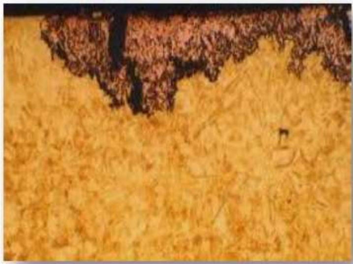
Εικόνα 3-5 «Αποψευδαργύρωση του ορείχαλκου σε δείγμα σωλήνα εναλάκτη»
