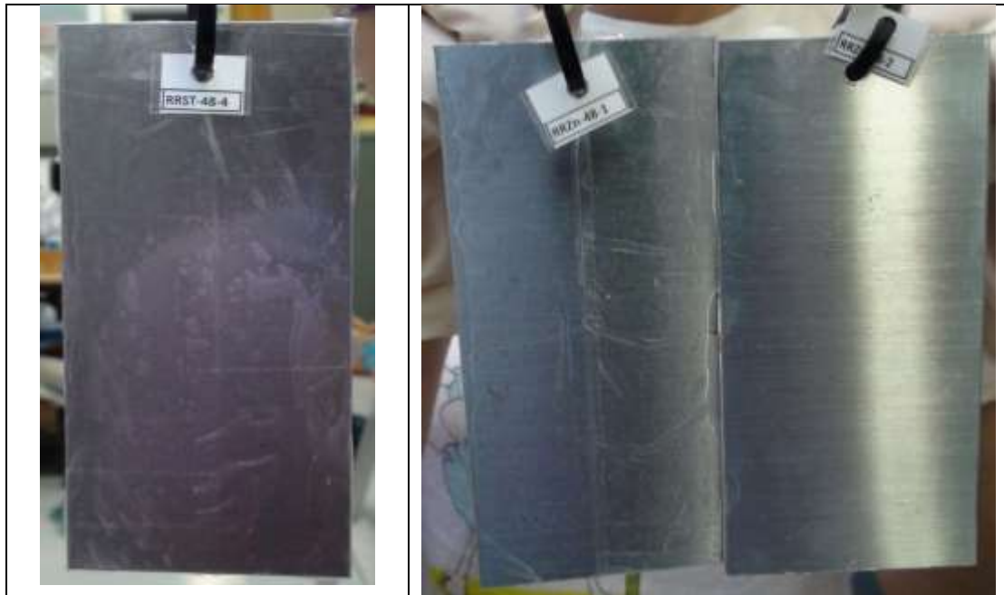
Εικόνα 6-7 «Δοκίμια αναφοράς πριν τη τοποθέτησή τους στον θάλαμο αλατονέφωσης»
