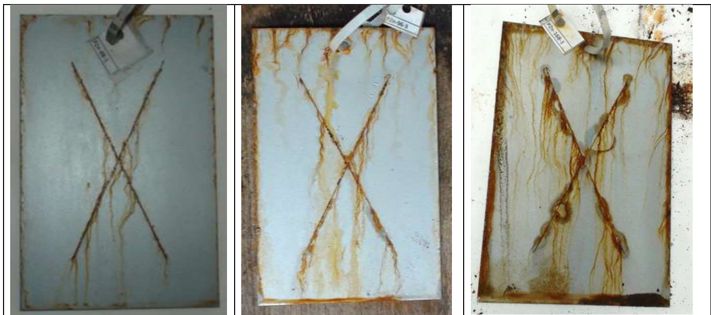
Εικόνα 6-26 «εποξειδικό σύστημα βαφής για:48 96 168 240 480 720 h»
