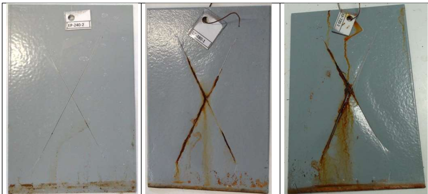
Εικόνα 6-26 «εποξειδικό σύστημα βαφής για:48 96 168 240 480 720 h»
