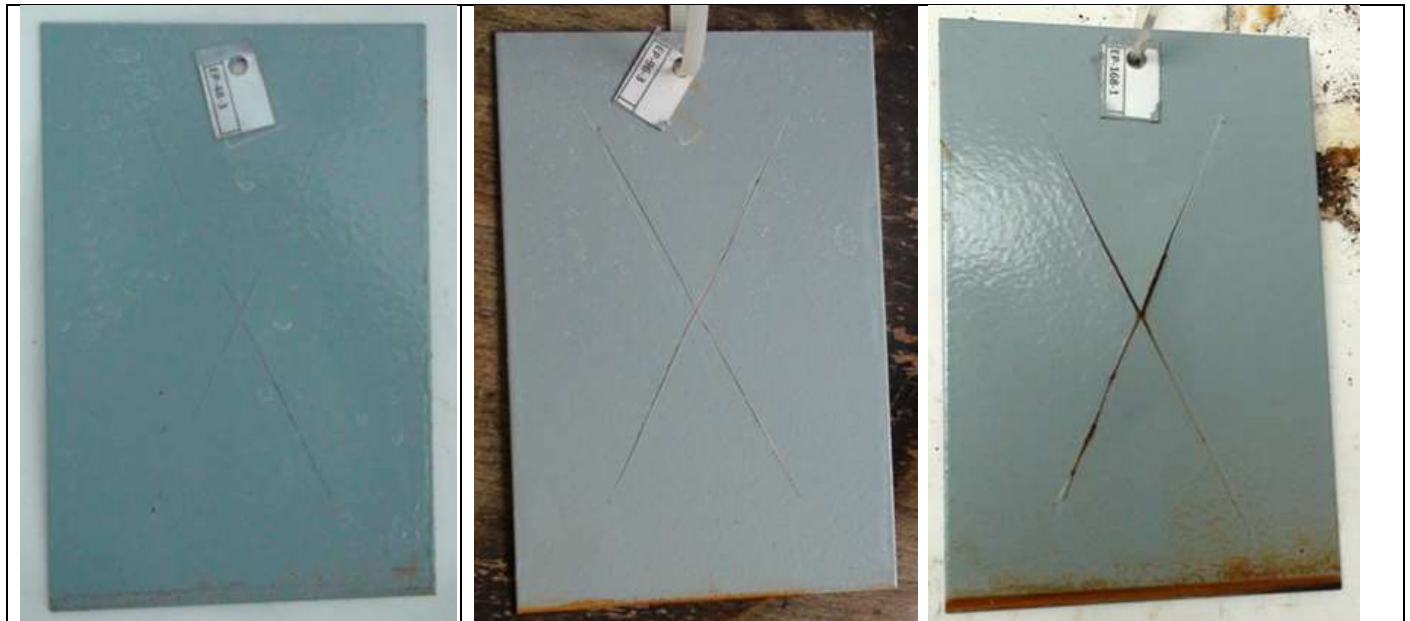
Εικόνα 6-25 «αλκυδικό σύστημα βαφής για έκθεση :48 96 168 240 480 720 h.»
