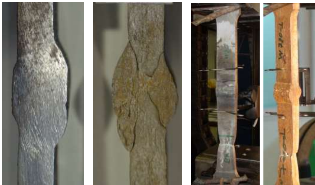
Εικόνα 6-28 «Συγκόλληση πριν και μετά τη διάβρωση. Σημείο θραύσης μη διαβρωμένου και διαβρωμένου δοκίμιου.»
