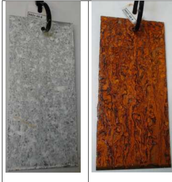
Εικόνα 6-9 «Δοκίμια ψευδαργύρου και χάλυβα μετά την εξαγωγή από το θάλαμο»
