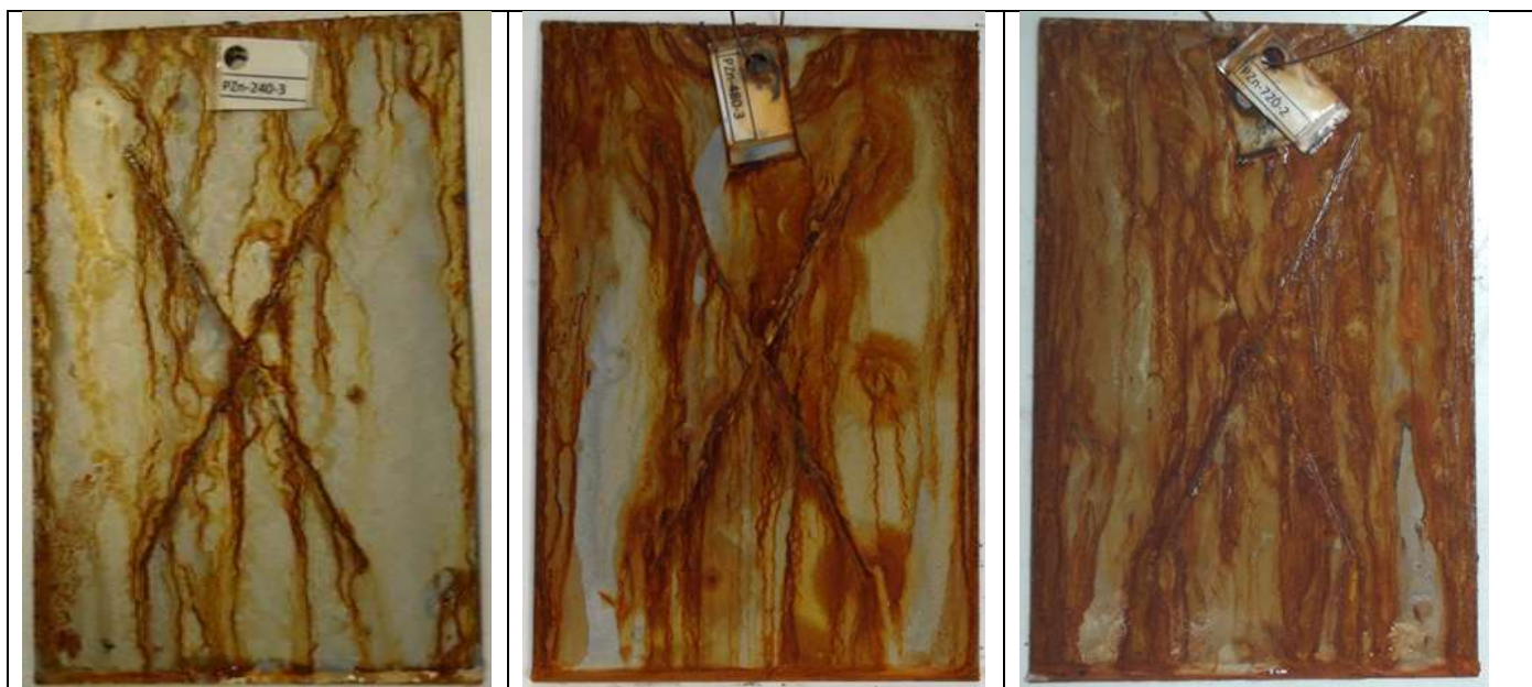
Εικόνα 6-27 « δοκίμια εν ψυχρώ γαλβανισμού για :48 96 168 240 480 720»
