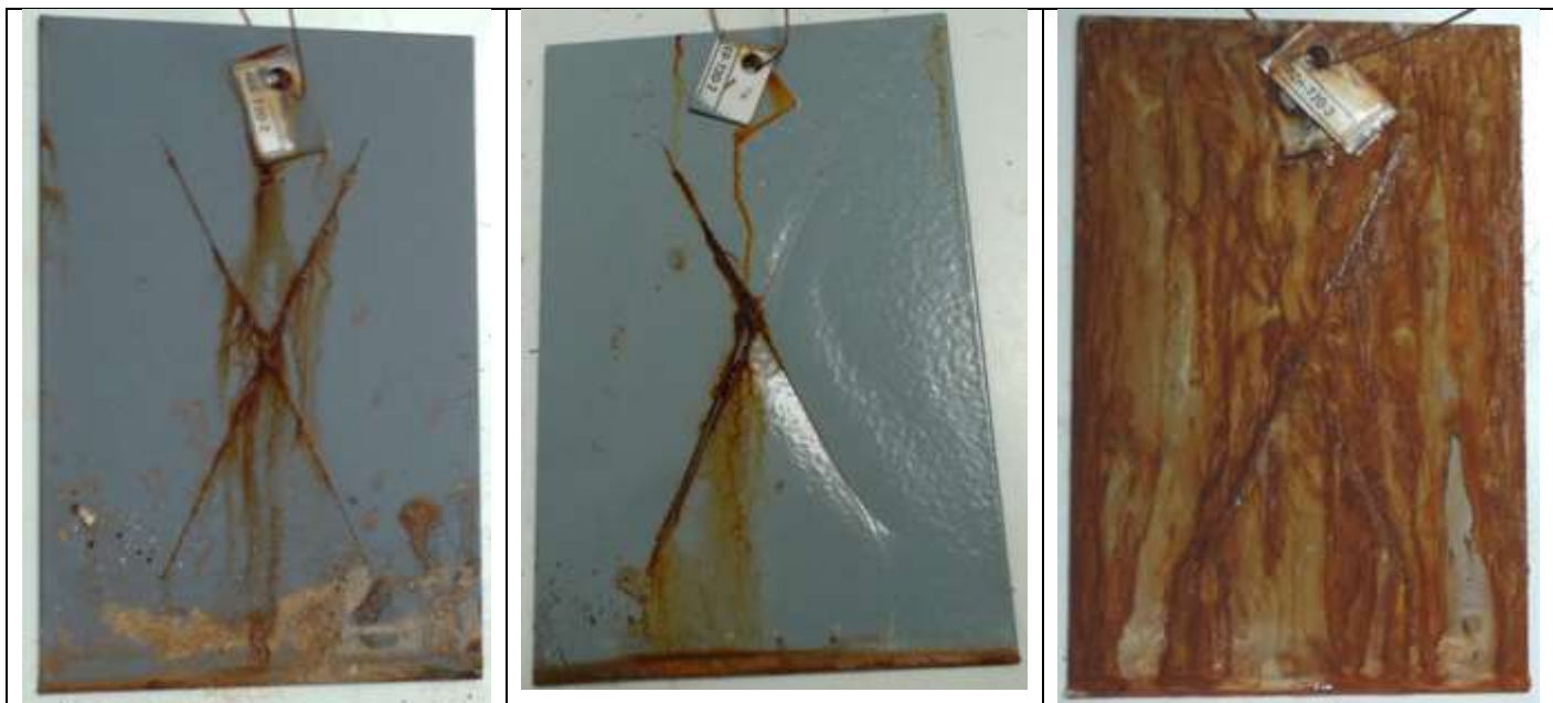
Εικόνα 6-24 «720 h έκθεσης. Σύστημα: αλκυδικό –εποξειδικό- γαλβανισμένο»
