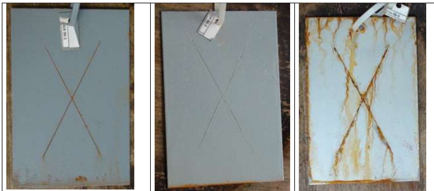
Εικόνα 6-20 «96 h έκθεσης. Σύστημα: αλκυδικό – εποξειδικό- γαλβανισμένο»
