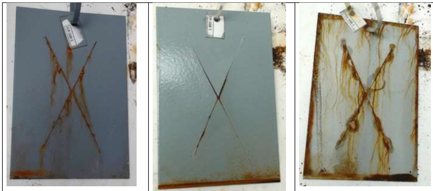
Εικόνα 6-21 «168 h έκθεσης. Σύστημα: αλκυδικό – εποξειδικό- γαλβανισμένο»
