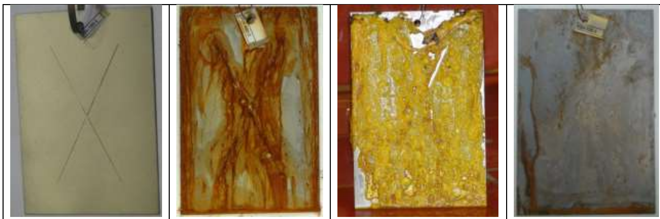
Εικόνα 6-14 «Διαδικασία καθαρισμού δοκιμίων»
