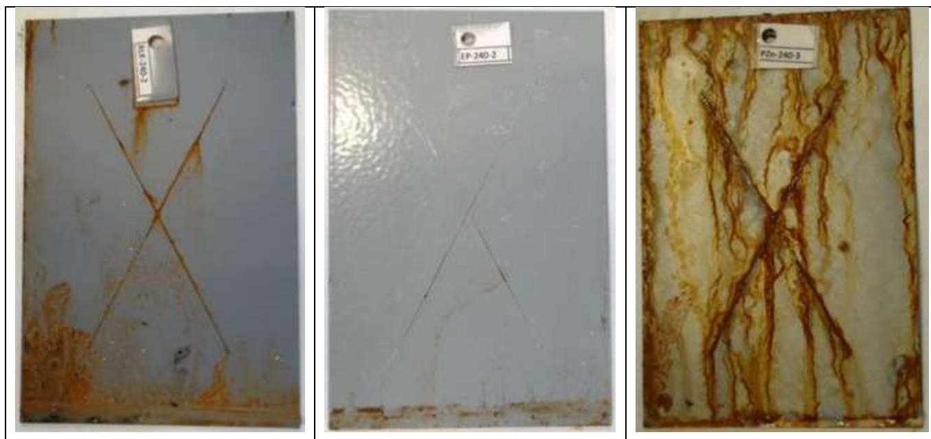
Εικόνα 6-22 «240 h έκθεσης. Σύστημα: αλκυδικό- εποξειδικό -γαλβανισμένο»
