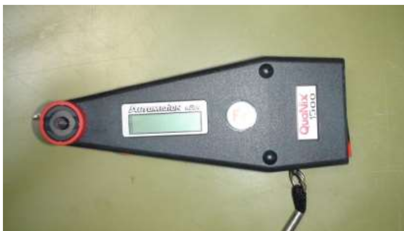
Εικόνα 6-12 «Ηλεκτρονικό παχύμετρο επικαλύψεων»
