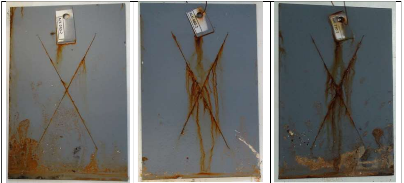
Εικόνα 6-25 «αλκυδικό σύστημα βαφής για έκθεση :48 96 168 240 480 720 h.»
