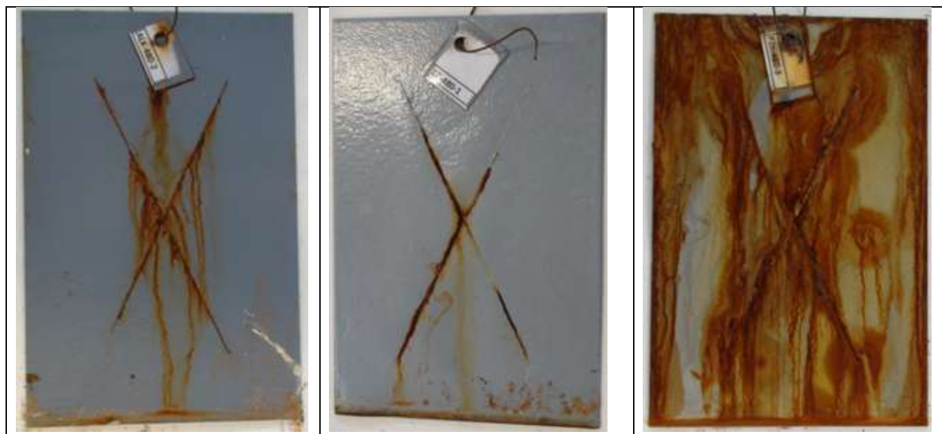
Εικόνα 6-23 «480 h έκθεσης. Σύστημα: αλκυδικό- εποξειδικό- γαλβανισμένο»
