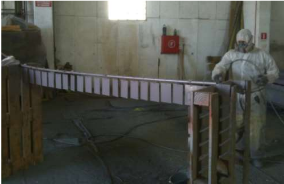
Εικόνα 6-10 «Διαδικασία βαψίματος δοκιμών στο εργοστάσιο»
