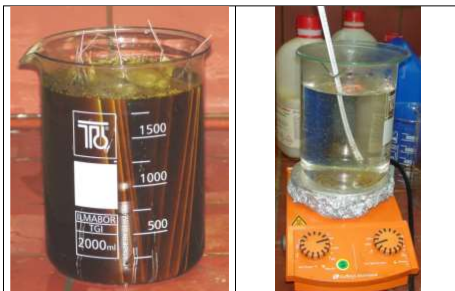
Εικόνα 6-8 «Διαλύματα καθαρισμού δοκιμών χάλυβα και ψευδαργύρου»
