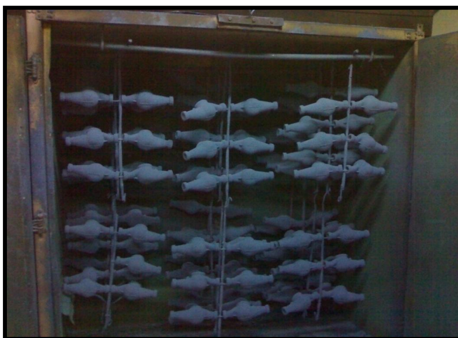
Εικόνα 3.16: Ανάρτηση των βαμμένων προϊόντων στο εσωτερικό του φούρνου
