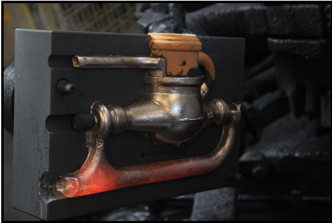
Εικόνα 3.8: Ο υδρομετρητής μετά την πήξη. Διακρίνονται τα προσεπιχωνεύματα και τα υπολείμματα του πυρήνα.
