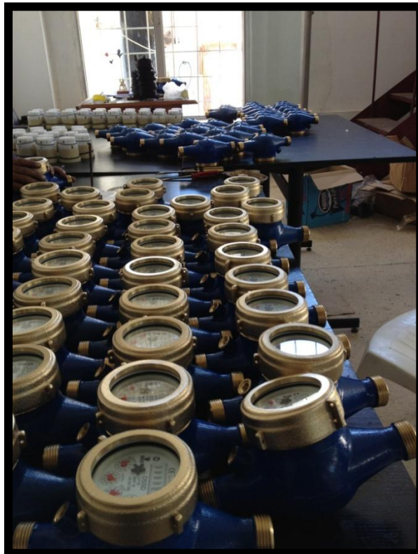
Εικόνα 3.25: Συναρμολογημένοι υδρομετρητές έτοιμοι για βαθμονόμηση
