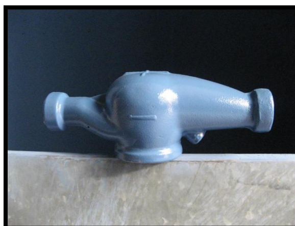
Εικόνα 3.17: Ο υδρομετρητής μετά το πέρας του φούρνου
