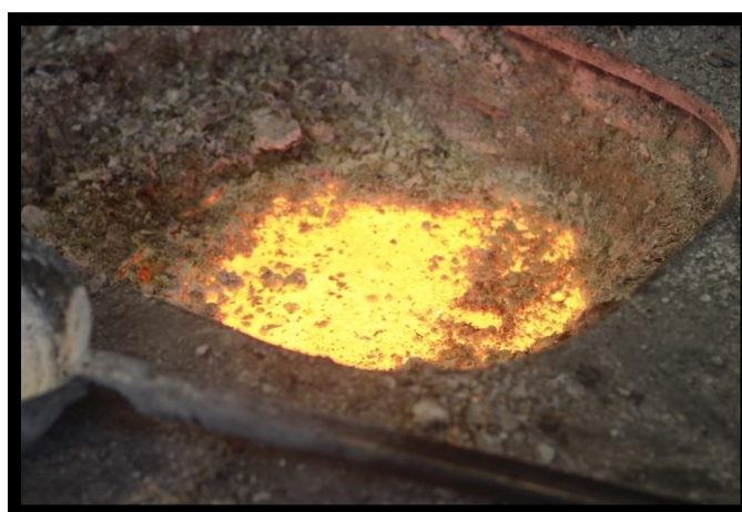
Εικόνα 3.4: Τήξη του ορείχαλκου
