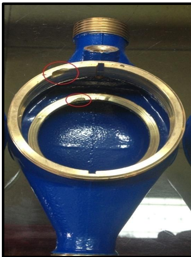
Εικόνα 3.41: Υδρομετρητής με αστοχίες
