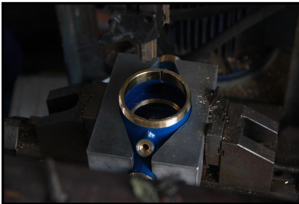
Εικόνα 3.22: Διάνοιξη εσωτερικών εσοχών
