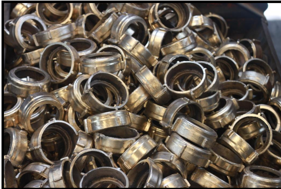
Εικόνα 3.11: Τα καπάκια μετά την κοπή των προσεπιχωνευμάτων
