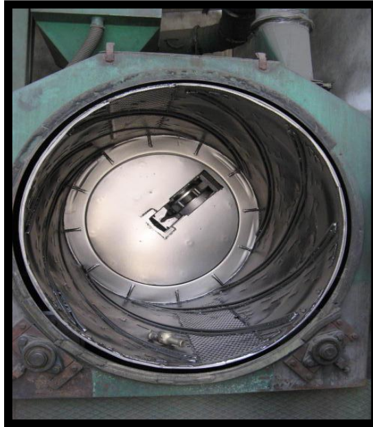
Εικόνα 3.14: Ο περιστρεφόμενος κάδος της βολής
