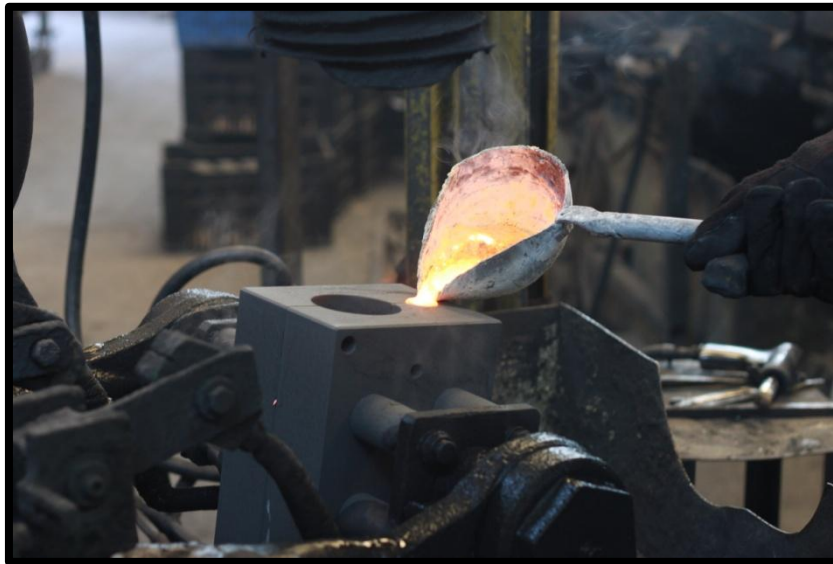
Εικόνα 3.7: Έγχυση ορείγαλκου στο καλούπι
