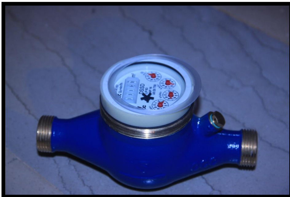
Εικόνα 3.30 : Τοποθέτηση άνω στεγανωτικού δακτυλίου (διαφανής)
