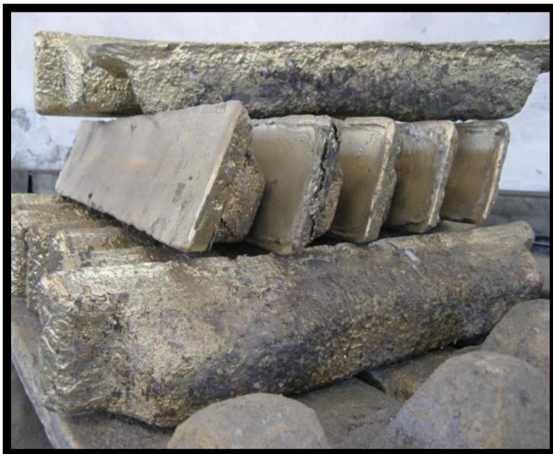
Εικόνα 3.5: Πρώτη ύλη – ορείχαλκος
