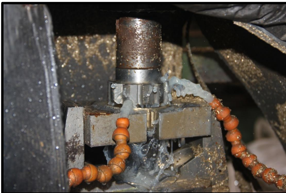
Εικόνα 3.24: Τόρνευση – σπείρωμα καπακιού
