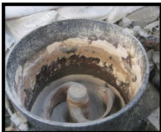
Εικόνα 3.2: Κάδος δημιουργίας μείγματος πυρήνα
