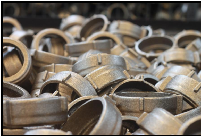
Εικόνα 3.15: Τα καπάκια μετά τη βολή
