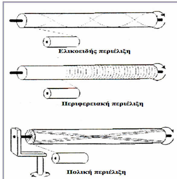
Σχήμα 3.7. Σχηματικές αναπαραστάσεις ελικοειδούς, περιφερειακής και πολικής (χιαστή) περιέλιξης νήματος [22]
