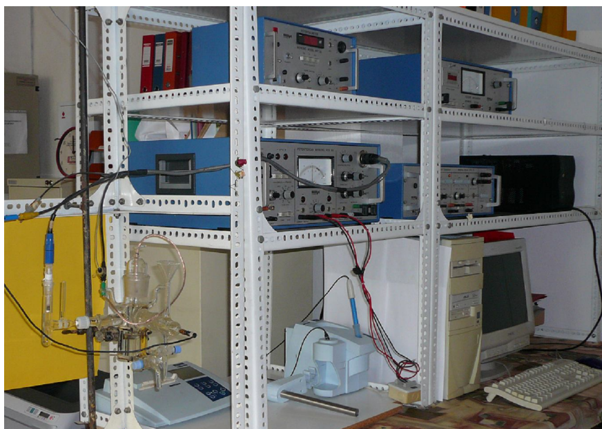
Φωτογραφία 5.1Α. Ηλεκτροχημικό κελί τριών χώρων ιδιοκατασκευής. Διάταξη κυκλικής βολταμετρίας
