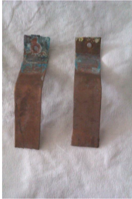
Σχήμα 5.5. Τα χάλκινα ηλεκτρόδια που κατασκευάστηκαν στο εργαστήριο, μετά από 40 κύκλους ηλεκτροχημικής επεξεργασίας. Τα σημάδια της διάβρωσης είναι εμφανή
