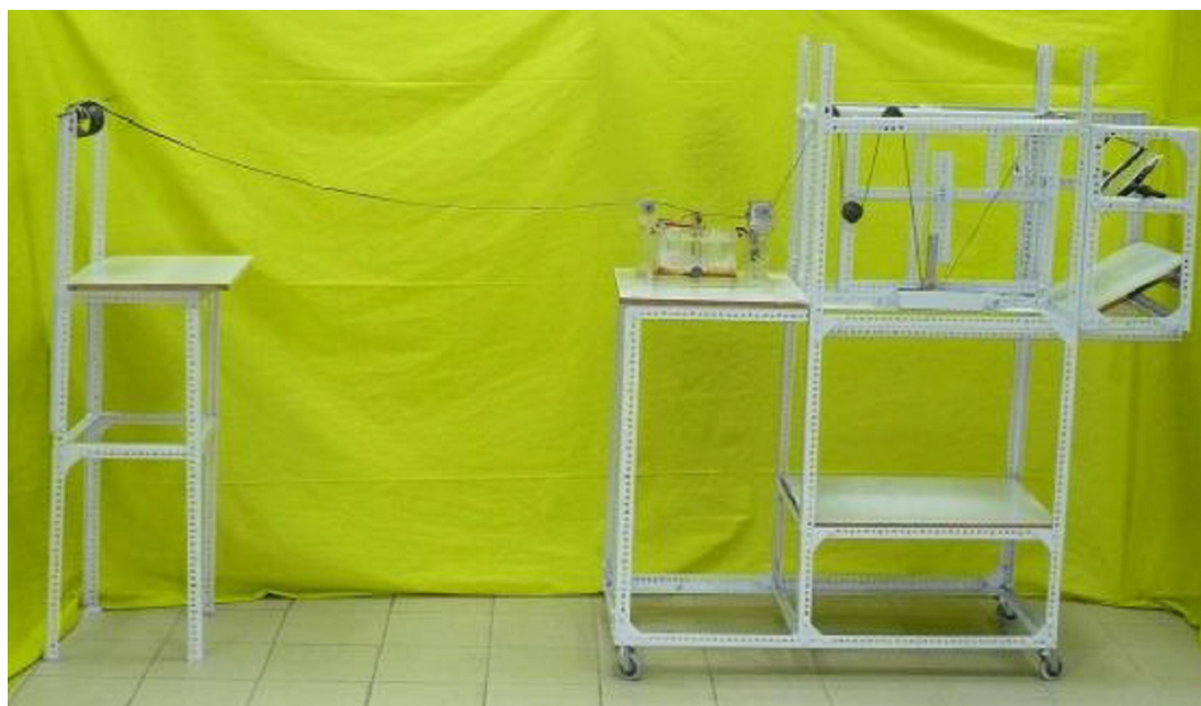
Σχήμα 8.15. Διάταξη διαβροχής των ινών άνθρακα
