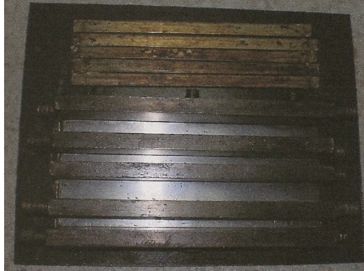
Σχήμα 8.17. Μεταλλικό καλούπι για την μορφοποίηση του τελικού σύνθετου με ίνες άνθρακα
