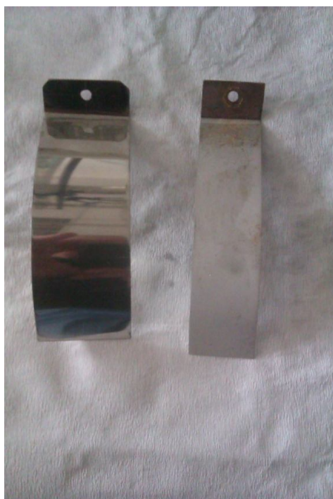
Σχήμα 5.4. Το ηλεκτρόδιο αριστερά είναι πριν χρησιμοποιηθεί και το δεξιά μετά από 40 κύκλους ηλεκτροχημικής επεξεργασίας
