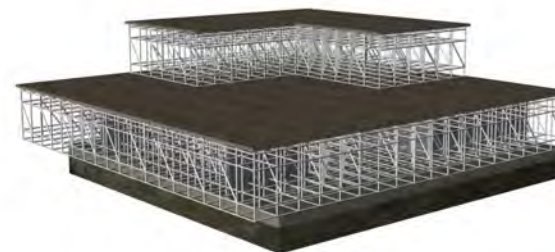
Εικόνα 33. Προσωρινές πλατφόρμες εργασίας. Σε αυτές ορίζονται εκ νέου τοπικά συστήματα συντεταγμένων για επί τόπου χαράξεις & τοποθετήσεις για τις “σκαλωσιές”
