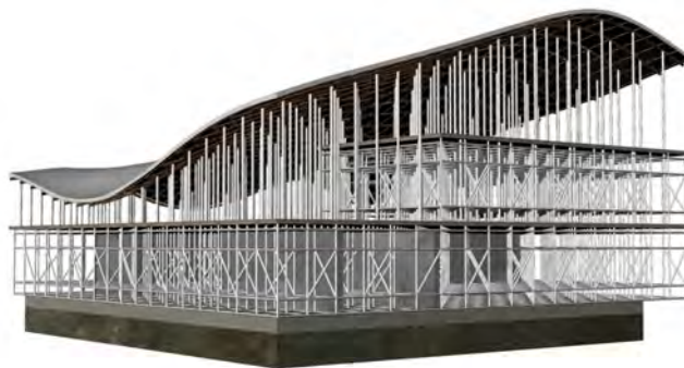
Εικόνα 47. Ψηφιακή αναπαράσταση του κατασκευαστικού μοντέλου του κτιρίου
