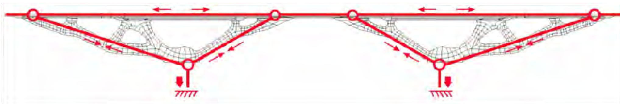
Εικόνα 68. Διαγραμματική απεικόνιση της στατικής λειτουργίας υπόστεγου και δενδροειδών ελκυστήρων
