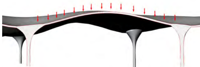
Εικόνα 48. Ομοιόμορφη κατανομή φορτίων στην πλάκα
