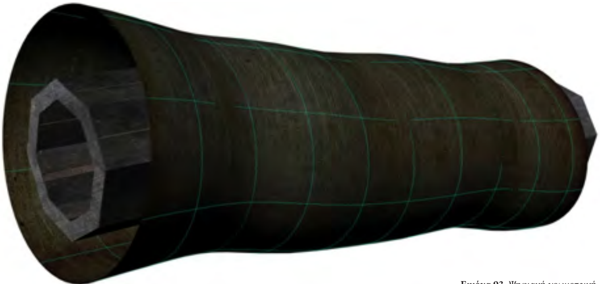
Εικόνα 93. Ψηφιακή γεωμετρική ανάλυση τμήματος κλαδιού. Οι γαλάζιες γραμμές είναι οι αρμοί των πλακών που θα προκύψουν από την ενιαία επιφάνεια.
