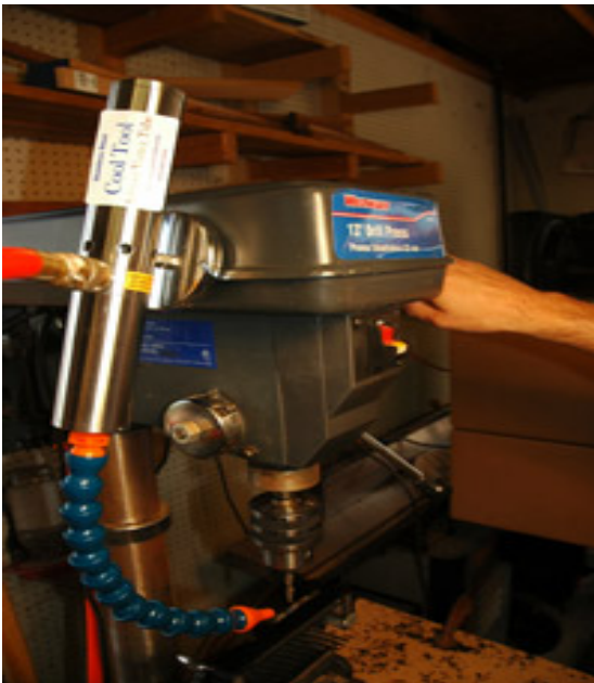
Σχήμα 1.7 Σωλήνας vortex της Arizona V.C. ενσωματωμένος σε τρυπανη.
