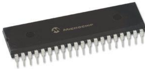
Σχήμα 5-10. Ο μικροεπεξεργαστής PIC18F4431 της Microchip.
