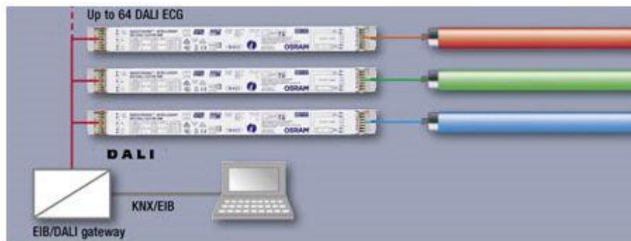
Εικ.1.55: Digital Addressable Lighting Interface Πηγή: [20]
