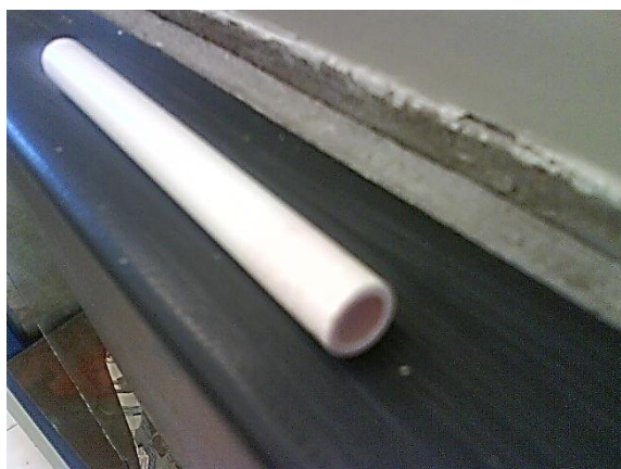
Εικόνα 1. Μεμβράνη \text{Al}_2\text{O}_3/\text{SiO}_2 που χρησιμοποιείται ως υπόστρωμα για τη χημική εναπόθεση ατμών (CVD). Το \text{SiO}_2 αποτελεί το εσωτερικό διαχωριστικό στρώμα με μέγεθος πόρων 1nm.
