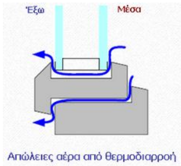
Εικ.2.2 Απώλειες διπλού υαλοπίνακα [3]
