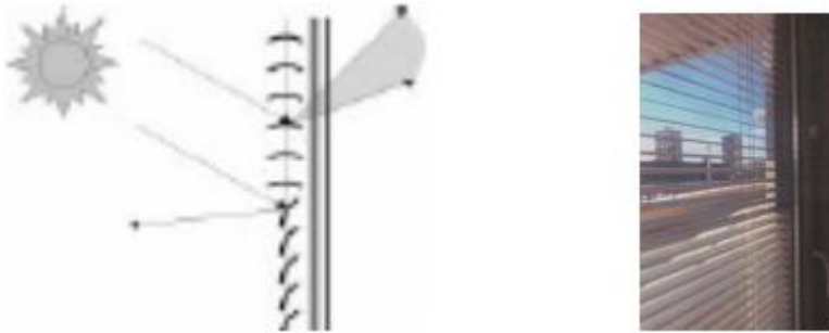
Εικ.3.5 Αριστερά: Ενδεικτική λειτουργία των κλασικών σκιαδίων – Δεξιά: Παράδειγμα χρήσης σκιαδίων ανάμεσα σε υαλοπετάσματα [5]
