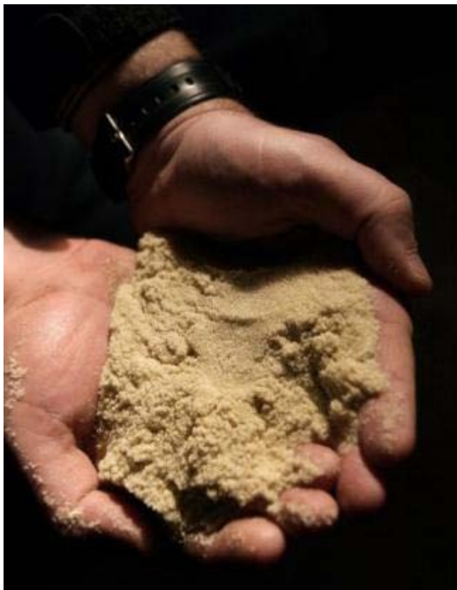
Εικόνα 4.10.: Πυριτική άμμος η οποία χρησιμοποιείται ως proppant κατά την διαδικασία της υδραυλικής ρωγμάτωσης (Minnesota Public Radio)
