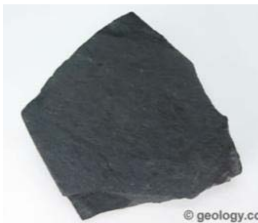
Εικόνα 2.9.: Σκουρόχρωμος σχιστόλιθος. Το μαύρο του χρώμα υποδεικνύει την ύπαρξη οργανικής ύλης (geology.com)
