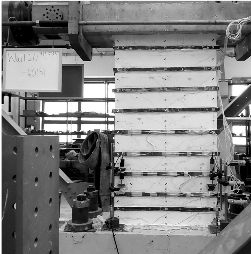
Εικόνα 7.24 Ρηγμάτωση του δοκιμίου κατά τον τρίτο κύκλο των -20mm
