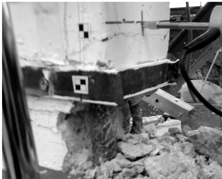
Εικόνα 7.30 Λυγισμός του θλιβόμενου οπλισμού
