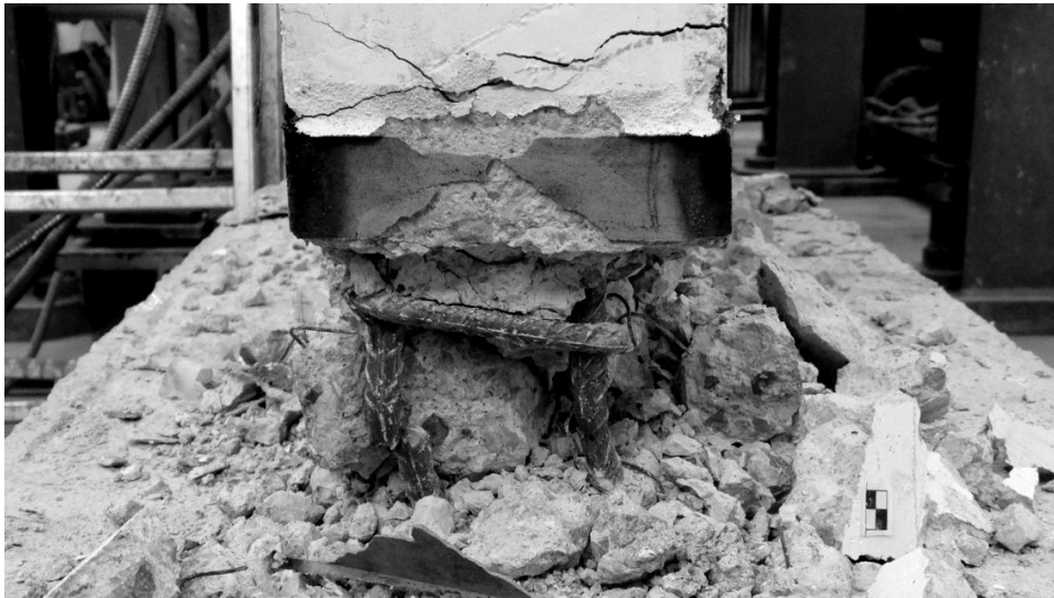
Εικόνα 7.19 Θράυση των διαμήκων εφελκόμενων ράβδων
