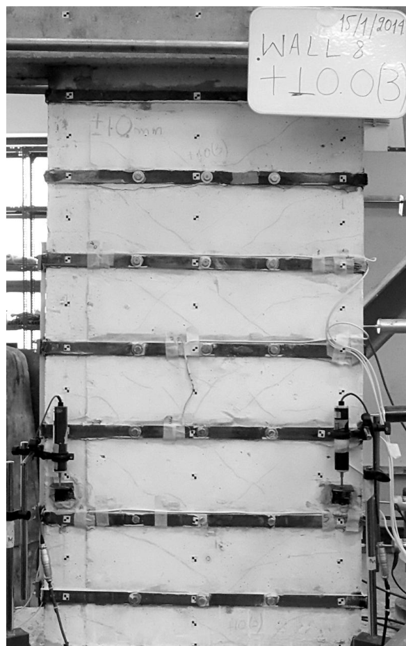
Εικόνα 7.14 Ρωγμές δοκιμίου στους κύκλους των \pm 10\text{mm}
