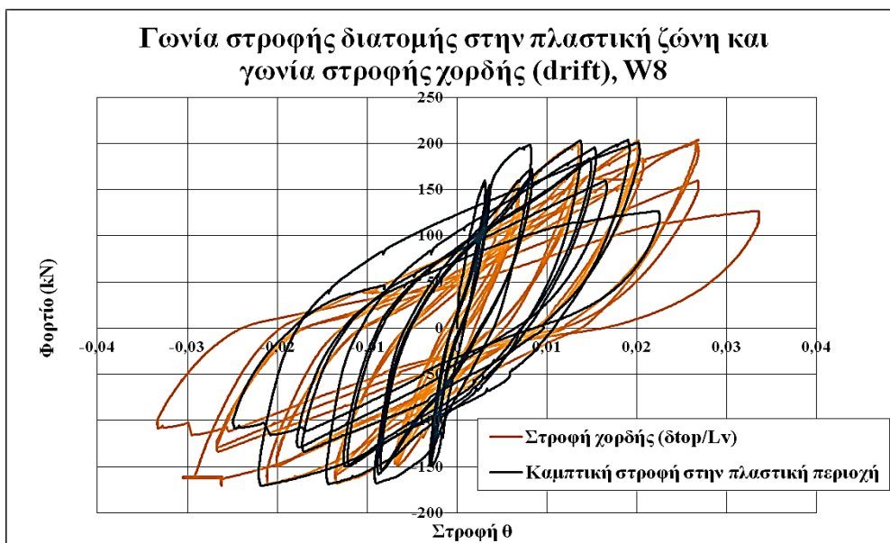
Διάγραμμα 7.52 Γωνία στροφής χορδής (drift) και καμπτική στροφή στην πλαστική ζώνη
