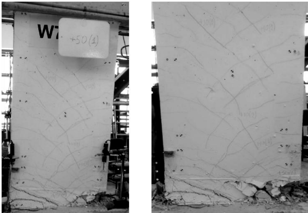
Εικόνα 5.7 Ρηγμάτωση δοκιμίου W7 στον κύκλο των +50\text{mm} και μετά το τέλος του πειράματος
