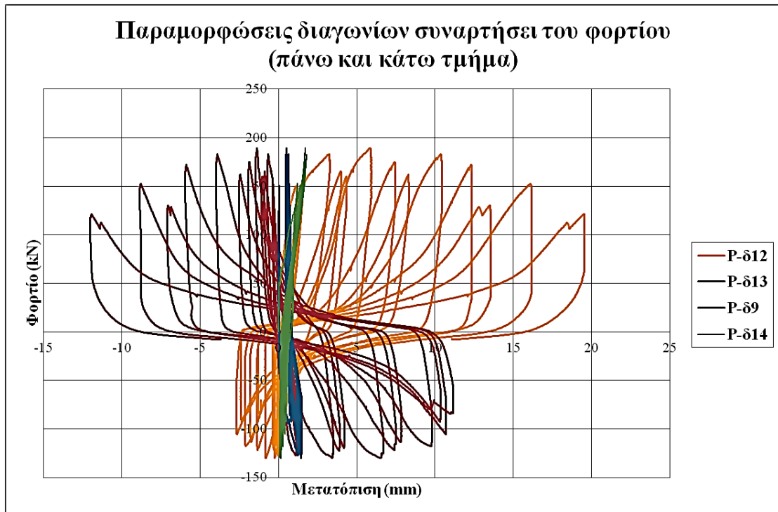
Διάγραμμα 7.56 Παραμορφώσεις διαγωνίων πάνω και κάτω τμήματος δσυναρτήσει του φορτίου (W10)
