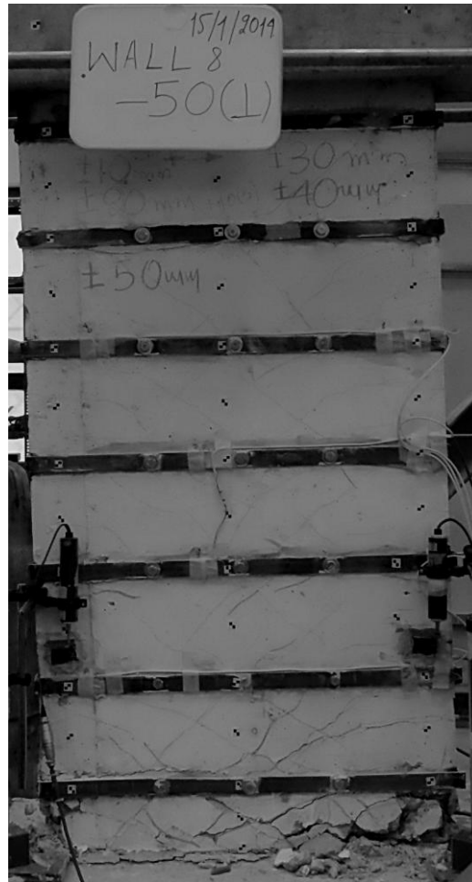
Εικόνα 7.18 Ρωγμές δοκιμίου στον κύκλο των \pm 50\text{mm} όπου θραύστηκε ο εφελκόμενος οπλισμός
