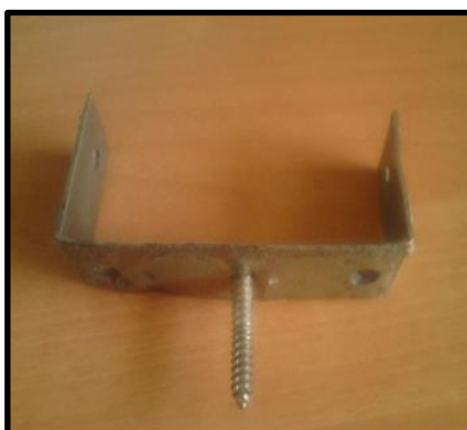
Εικόνα 5.1: Ειδική κατασκευή για σημειακή εφαρμογή της σταδίας Picture 5.1: Special construction used for the levelling
