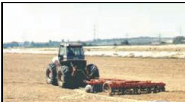
Σχήμα 4.9. : Καθαρισμός λεκάνης εμπλουτισμού (SAT) με μηχανικά μέσα (Cikurel & Aharoni, Aquarec, 2005)
