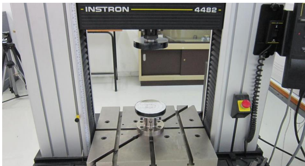
Σχήμα 3.5: Εργαλείο θλίψης προσαρμοσμένο στη μηχανική πρέσα INSTRON
