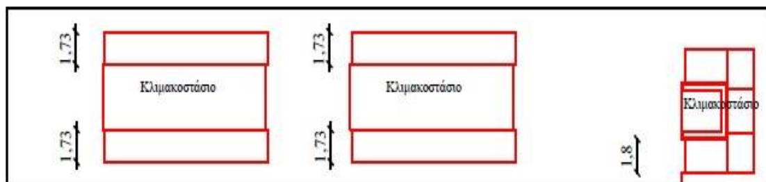
Σχήμα 8.12: Σκαρίφημα απεικόνισης του ενδιάμεσου επιπέδου για τον υπολογισμό της δυναμικότητας της όδευσης διαφυγής
