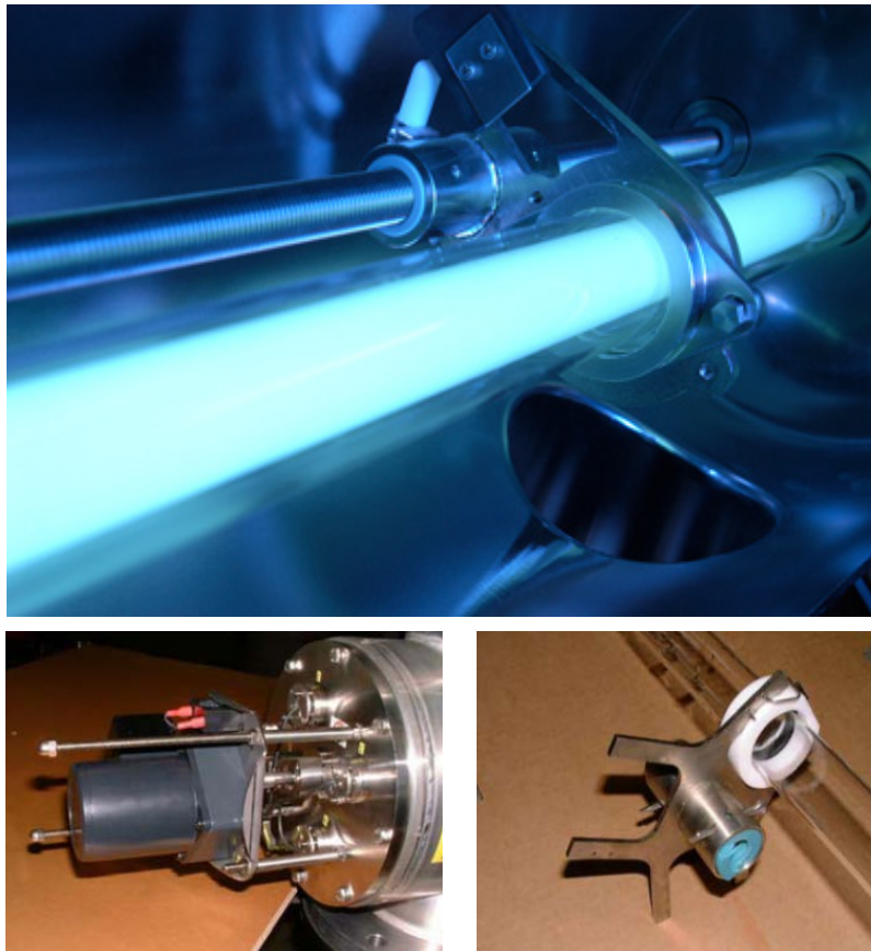
Εικόνα 3.7: Λαμπτήρας U.V. και σύστημα καθαρισμού
