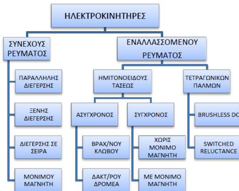
Σχήμα 7: Βασικές αρχές- εναλλακτικές ηλεκτρικού κινητήρα
