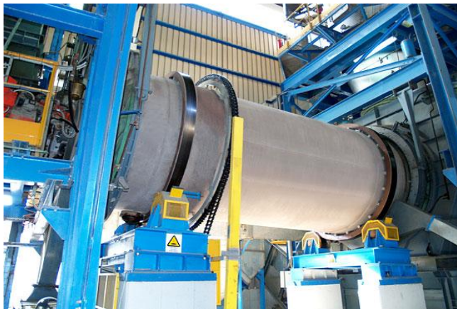
Εικόνα 6-3: Ο κεκλιμένος ομόρου τύπου περιστρεφόμενος κλίβανος [20].
