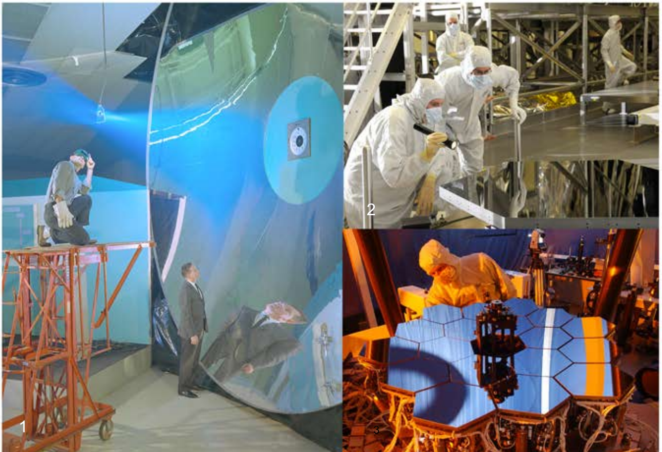
2. Επίβλεψη πολύγωνου καθρέφτη τηλεσκοπίου τύπου JWST. 3. Συναρμολόγηση πολύγωνων καθρεφτών με ρομποτικό κινητικό που ελέγχει την κίνησή τους για ρύθμιση της εστίασης.
