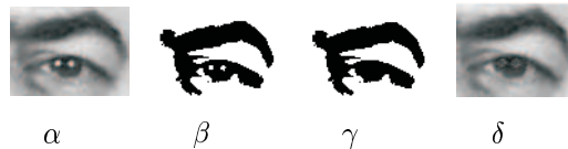
Σχήμα 2.7: Διαδικασία αφαίρεσης αντανακλάσεων: (α) περιοχή ματιού, (β) δυαδική περιοχή ματιού, (γ) δυαδική περιοχή ματιού με αφαιρεμένες τις περιοχές αντανακλάσεων, (δ) ασπρόμαυρη περιοχή ματιού με αφαιρεμένες τις περιοχές αντανακλάσεων
