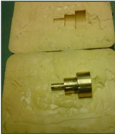
Σχήμα 2.5 Τα δύο τμήματα του λαστιχένιου καλούπι, μετά το ψήσιμό του.
