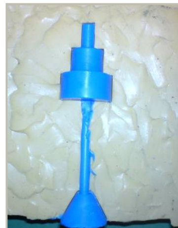
Σχήμα 2.8 Το σχηματιζόμενο κέρινο ομοίωμα, μαζί με τον δευτερεύοντα αγωγό τροφοδοσίας.
