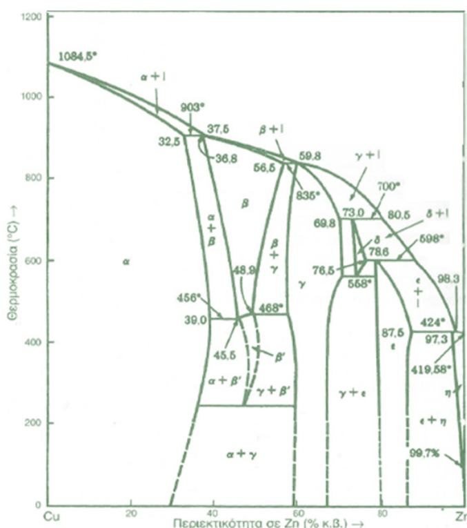
Σχήμα 2.30 Διάγραμμα ισορροπίας των φάσεων του διμερούς κράματος Cu-Zn.
