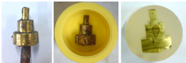
Σχήμα 2.51 Μεθοδολογία που ακολουθήθηκε για τα δείγματα που προετοιμάστηκαν για τη μεταλλογραφική μελέτη.
