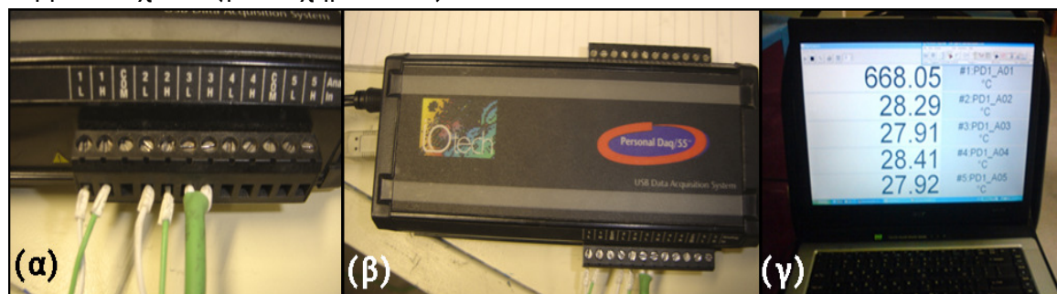
Σχήμα 2.42 (α) Σύνδεση θερμοστοιχείων στο μετατροπέα, (β) Ο αναλογικο-ψηφιακός μετατροπέας που χρησιμοποιήθηκε, (γ) Η απευθείας απεικόνιση των μετρήσεων σε laptop.
