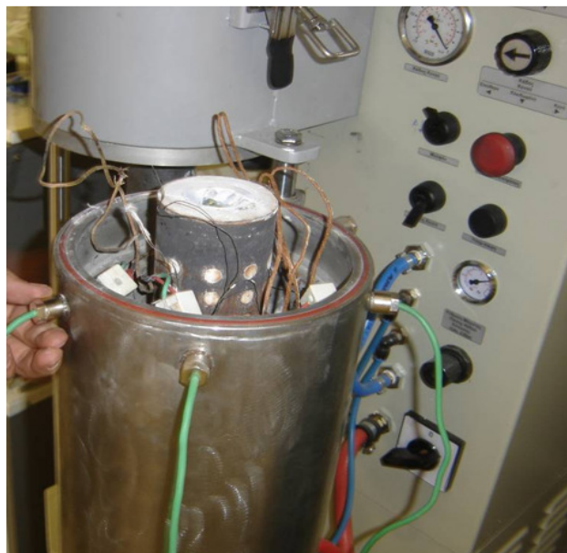
Σχήμα 2.26 Ο θάλαμος χύτευσης της μηχανής χύτευσης κενού με την τροποποίηση για την τοποθέτηση θερμοστοιχείων.
