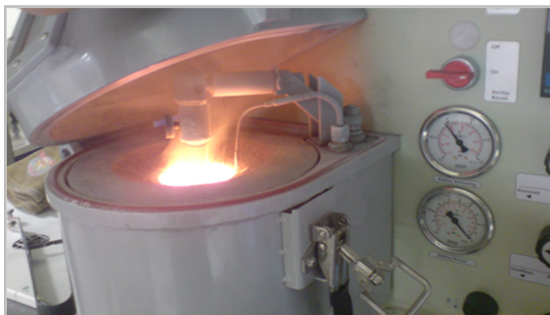
Σχήμα 2.19 Ο θάλαμος τήξης της μηχανής χύτευσης.
