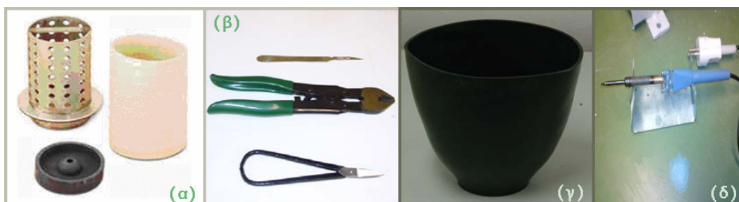
Σχήμα 2.2 (α) Η διάτρητη φλάσκα με τη λαστιχένια βάση και το λαστιχένιο κολάρο, (β) Νυστέρι, κόφτης και ψαλίδι, (γ) Μπολ ανάμιξης (δ) Κολλητήρι.
