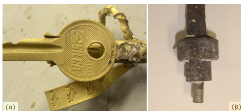
Σχήμα 2.37 Δοκιμαστικά χυτά από (α) επιτυχημένη χύτευση ορείχαλκου και (β) από αποτυχημένη χύτευση αλφακά.
