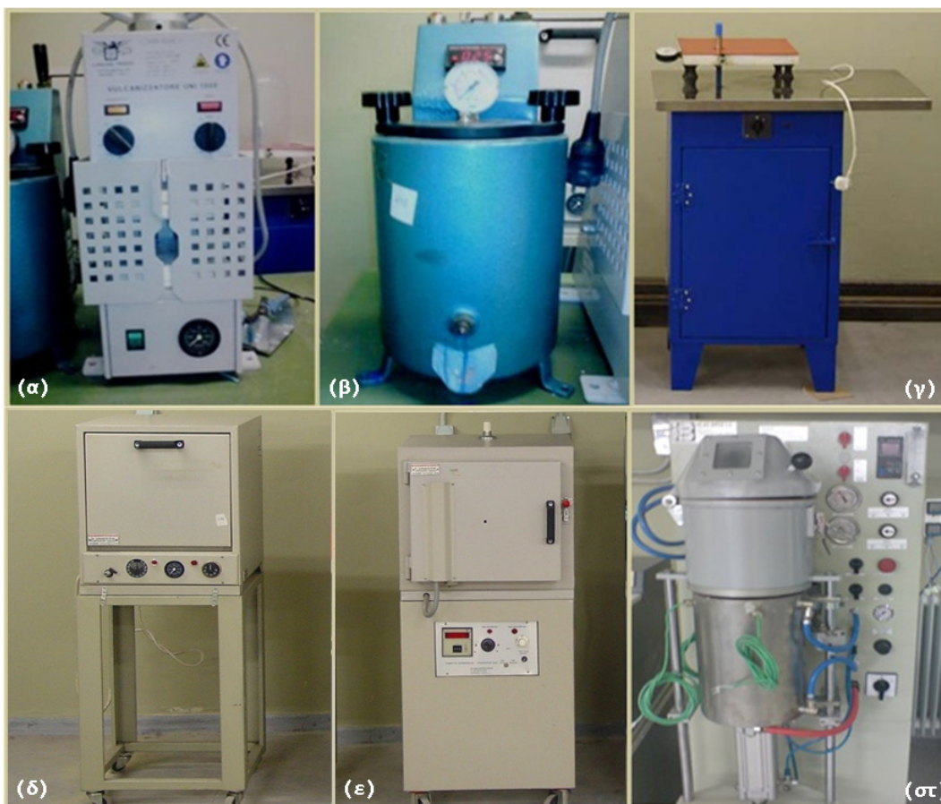
Σχήμα 2.1 (α) Λαστιχέρα, (β) Κεριέρα, (γ) Εξαερωτής, (δ) Φούρνος αποκέρωσης, (ε) Φούρνος ψησίματος, (στ) Μηχανή χύτευσης κενού-υπερπίεσης.
