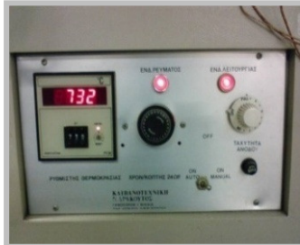
Σχήμα 2.12. Η ρύθμιση της θερμοκρασίας ψησίματος του καλούπιου
