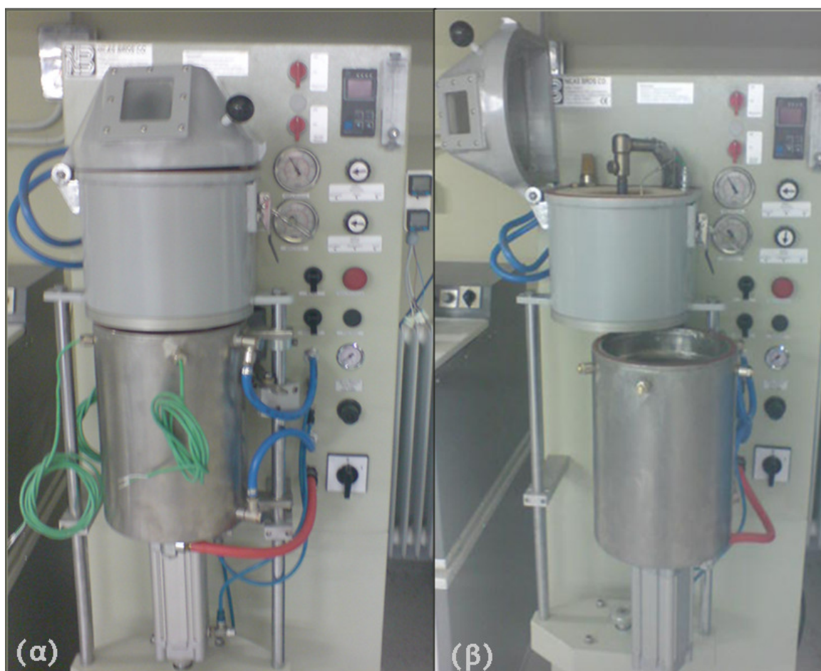
Σχήμα 2.24 Η μηχανή χύτευσης κενού-υπερπίεσης του εργαστηρίου: (α) κλειστή και (β) με ανοιχτό τον κάδο τήξης και τον κάδο χύτευσης.
