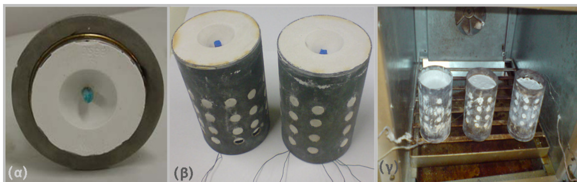
Σχήμα 2.11 (α) Καλούπι μετά τη στερεοποίηση του γύψου και την απομάκρυνση της λαστιχένιας βάσης, (β) Καλούπια πριν την αποκέρωση. Διακρίνονται τα καλώδια των θερμοστοιχείων, (γ) Καλούπια μέσα στον αποκερωτή.
